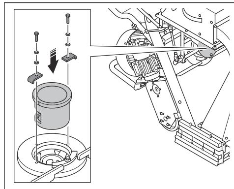
5. Coloque los 8 tornillos, las 16 arandelas, las 8 tuercas y la tolva.
