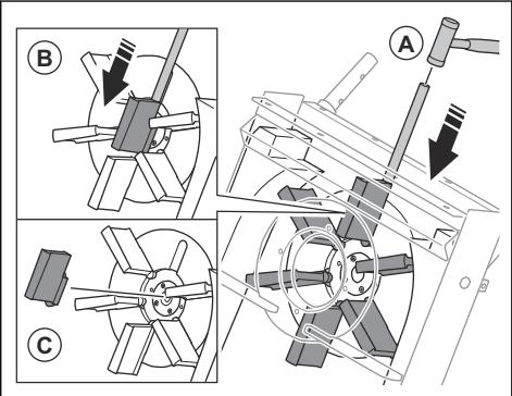
6. Spingere verso il basso le lame della ruota di pallinatura (B).
