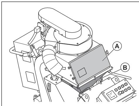
O tabuleiro do separador afasta a contaminação do material abrasivo e das lâminas da roda de granulagem.
