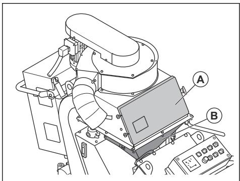
La bandeja separadora impide la contaminación del material abrasivo y las palas de la turbina de granallado.
