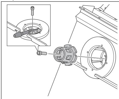
3. Bloqueie as lâminas da roda de granalhagem com uma ferramenta aplicável e instale o parafuso do impulsor.
