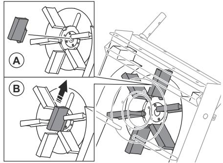
4. Deslice las palas de la turbina de granallado hasta las ranuras (B).
