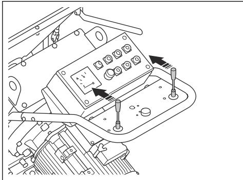
6. Puxe a alavanca de controlo do material abrasivo para abrir a válvula. Consulte *Utilizar a válvula do material abrasivo na página 115*.
