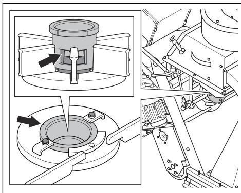
6. Gire la caja de control hacia la derecha si el punto caliente está demasiado en el lado derecho.
