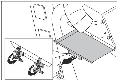
4. Abasteça o separador com material abrasivo até ao tabuleiro do separador. Abasteça o separador com material abrasivo sempre que necessário.
