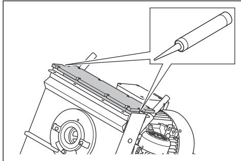
9. Inserire le 8 viti, le 16 rondelle, gli 8 dadi e il coperchio del rivestimento superiore.
