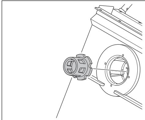
3. Μπλοκάρετε τους δίσκους των τροχών σφαιριδιοβολής με ένα κατάλληλο εργαλείο και τοποθετήστε το μπουλόνι της φτερωτής.
