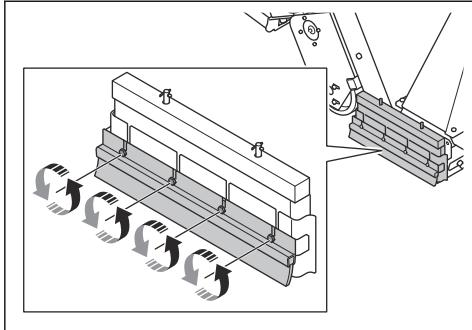
2. Ajuste las juntas de la banda de cepillado hasta que la altura esté 1 mm/0,04 pulg. por encima de la superficie.
