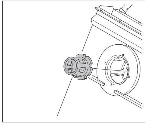
3. Bloccare le lame della ruota di pallinatura con un utensile adatto e inserire il bullone della girante.
