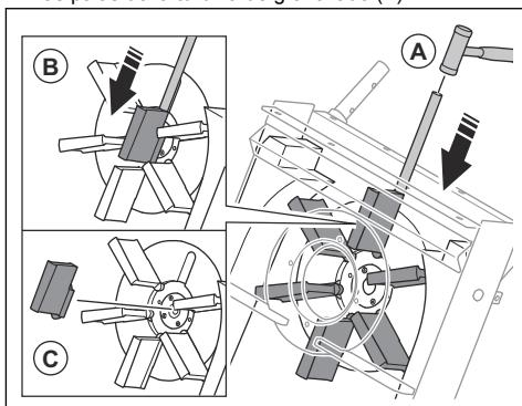
6. Empuje hacia abajo las palas de la turbina de granallado (B).
