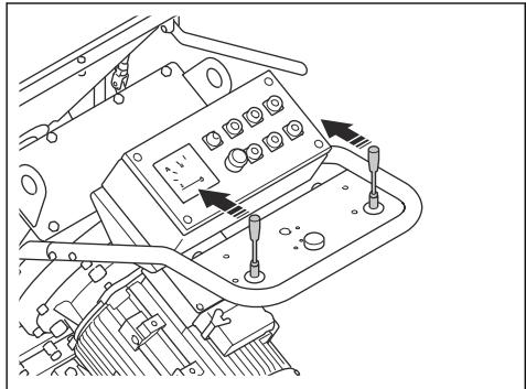
6. Tire de la palanca de control del material abrasivo para abrir la válvula. Consulte *Accionamiento de la válvula de material abrasivo en la página 48*.
