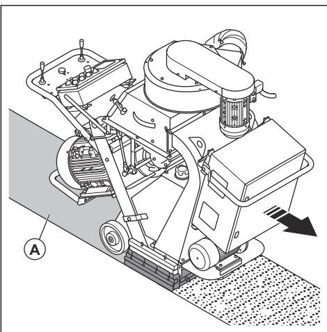
Para obtener un buen resultado, el punto caliente debe estar en el centro del patrón de granallado. Si el punto caliente está demasiado a la izquierda o a la derecha, gire la caja de control. Consulte *Ajuste del patrón de granallado en la página 53*.
