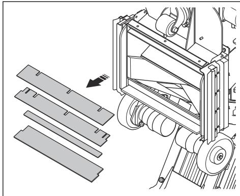
c) Installare le nuove guarnizioni in gomma anteriori (C) con le strisce di acciaio (D) interposte tra le guarnizioni in gomma anteriori. La striscia angolare (E) fa parte della scocca e non può essere rimossa.
