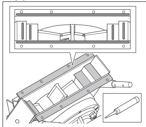
7. Levante el revestimiento superior de las ranuras por los laterales (C) e instálelo en la carcasa. Asegúrese de que el revestimiento superior está correctamente alineado con la carcasa.
