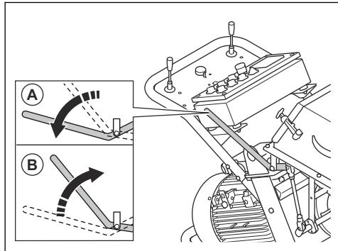
2. Azionare la leva di comando del materiale abrasivo (B) per aprire la valvola e avviare il flusso del materiale abrasivo.
