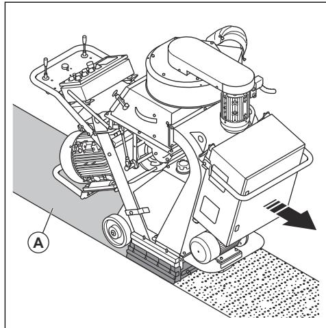
Per ottenere un buon risultato, il punto critico deve trovarsi al centro dello schema di pallinatura. Se il punto critico è troppo a sinistra o a destra, ruotare la gabbia di controllo. Fare riferimento a *Regolazione dello schema di pallinatura alla pagina 86*.
