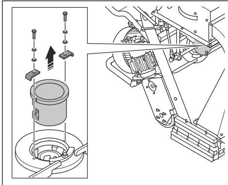
5. Inserire un utensile idoneo nelle lame della ruota di pallinatura per impedire la rotazione. Rimuovere il bullone e gettarlo.
