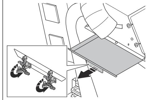
4. Riempire il separatore con materiale abrasivo fino al vassoio. Riempire il separatore con materiale abrasivo quando necessario.
