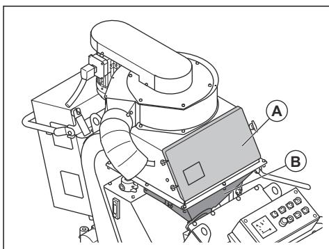
Ο δίσκος του διαχωριστή απομακρύνει τους ρύπους από το λειαντικό υλικό και τους δίσκους των τροχών σφαιριδιοβολής.
