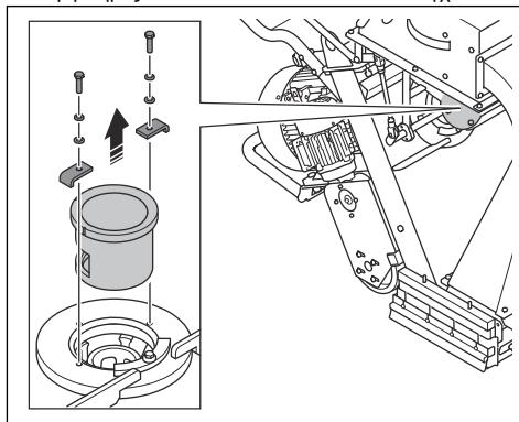
5. Τοποθετήστε ένα κατάλληλο εργαλείο στους δίσκους των τροχών σφαιριδιοβολής για να αποτρέψετε την περιστροφή. Αφαιρέστε το μπουλόνι και απορρίψτε το.
