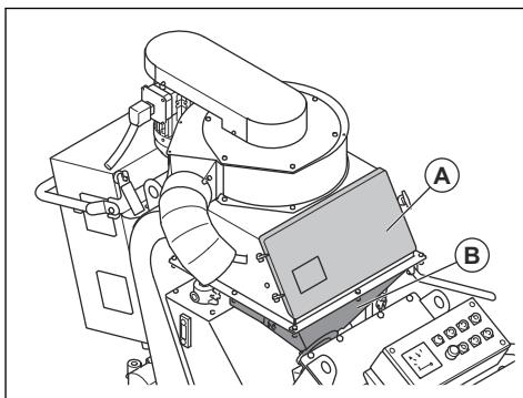
Il vassoio del separatore impedisce la contaminazione dell'abrasivo e delle lame della ruota di pallinatura.
