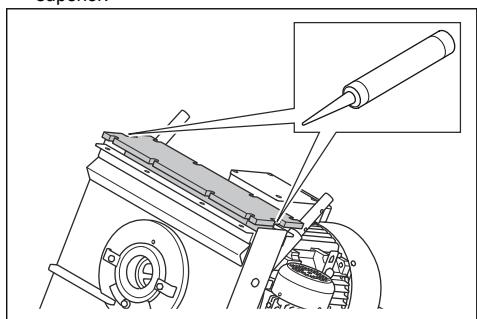
9. Coloque los 8 tornillos, las 16 arandelas, las 8 tuercas y la cubierta del revestimiento superior.
