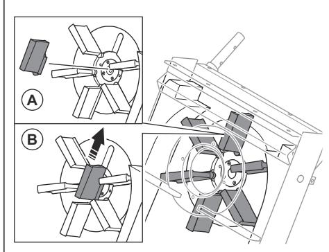
4. Deslize as lâminas da roda de granalhagem para as ranhuras (B).
