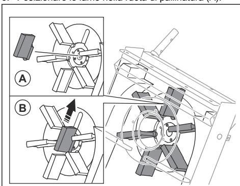
4. Far scorrere le lame della ruota di pallinatura nelle fessure (B).
