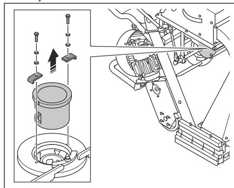
5. Coloque uma ferramenta aplicável nas lâminas da roda de granalhagem para evitar a rotação. Remova o parafuso e elimine-o.
