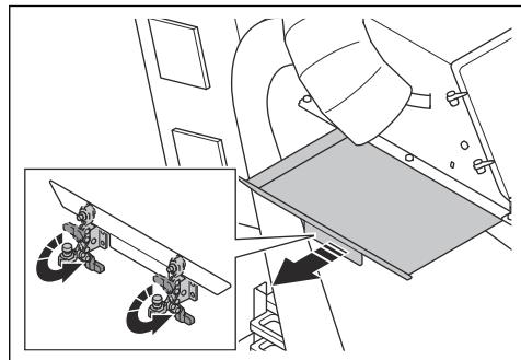
4. Llene el separador con material abrasivo hasta la bandeja separadora. Rellene el separador con material abrasivo cuando sea necesario.
