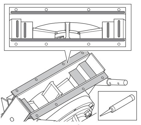
7. Sollevare il rivestimento superiore nelle fessure laterali (C) e installarlo sull'alloggiamento. Assicurarsi che il rivestimento superiore sia correttamente allineato con l'alloggiamento.
