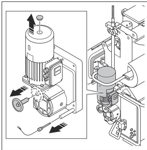
2. 将手轮穿过孔安装到电机轴上。推动释放杆穿过电机外壳中的开口，推到制动器上的支架上。
