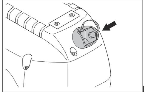
2. ووصل الطرف الآخر من كابل ناقل شبكة وحدة التحكم (CAN) في الموصل (A) الموجود على الحاوية الكهربائية.
