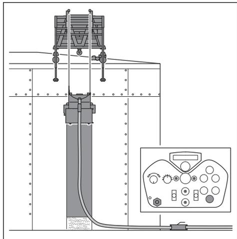
10. 2 ウェイバルブのハンドルを回して、吸引力 (A) を下げます。本製品が表面から放されます。
