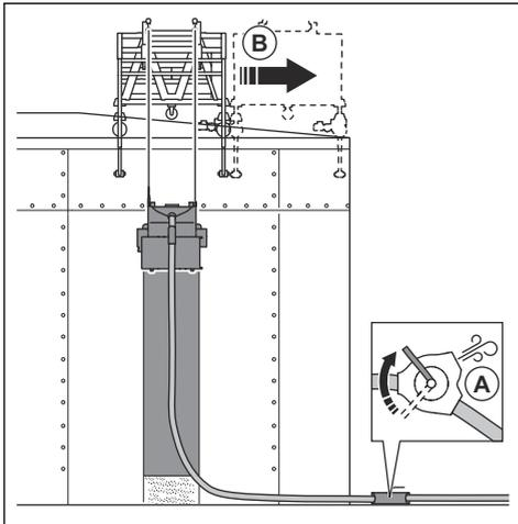
11. 리깅 시스템(B)을 오른쪽으로 이동합니다. 지침은 리깅 시스템의 사용자 설명서를 참조하십시오.
