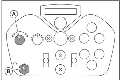
3. 将遥控器上的移动操纵杆 (B) 向前推以启动绞盘电机。
