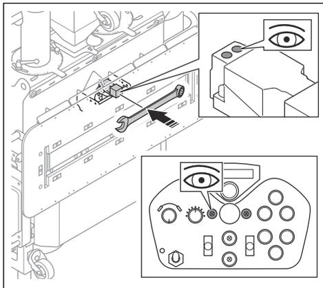
3. 金属製の物体を取り除きます。近接スイッチおよびリモートコントロールの関連するインジケータが消灯します。
