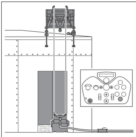
16. 2 ウェイバルブのハンドルを回して吸引力を下げます。本製品が表面から放されます。
