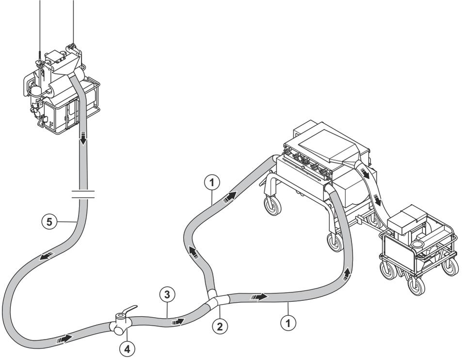
3. وصل خرطوم شفط الغبار مقاس 15 مترًا/50 قدمًا بجهاز تجميع الغبار باستخدام مشابك الخرطوم والشريط الصناعي.
