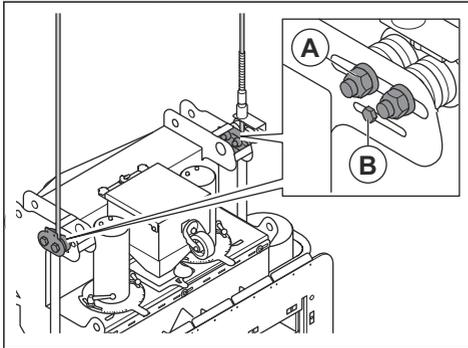
3. 调整松动的滚轮，直至磨料密封件与表面平行，然后拧紧螺母和螺栓。
