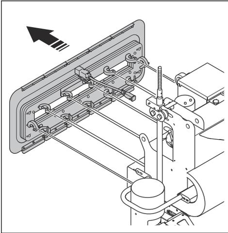
4. 新品の研磨材シールを逆の手順で取り付けます。
