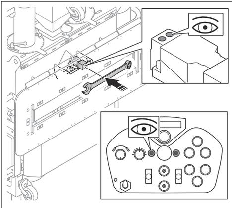
3. 移除金属物体。接近开关和遥控器上的相关指示灯会熄灭。
