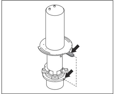
6. 确保控制笼的槽口与控制笼环的槽口对齐。
