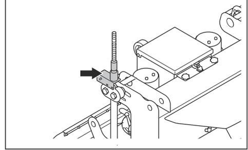
يمنع المفتاح الحدي تلف المنتج ونظام الرفع عندما يكون المنتج عند الجزء العلوي من أحبال أسلاك الفولاذ. وإذا تم تعشيق المفتاح الحدي، فسيستوقف التحريك لأعلى وسيتمكن تحريك المنتج لأسفل فقط.
