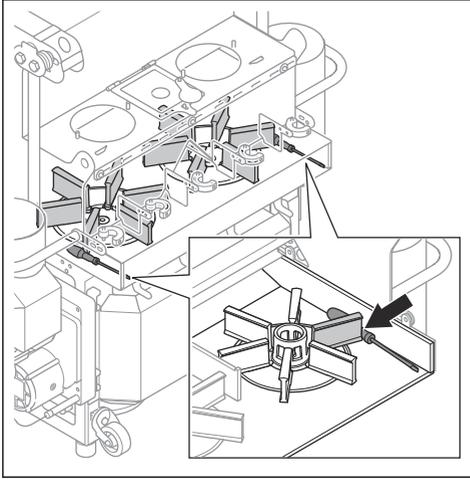
4. 拆下螺栓和叶轮。丢弃螺栓。
