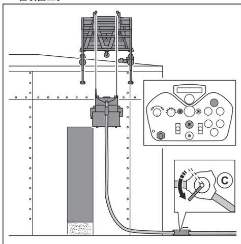
13. 向下操作产品，并在移动过程中打开磨料阀门。
