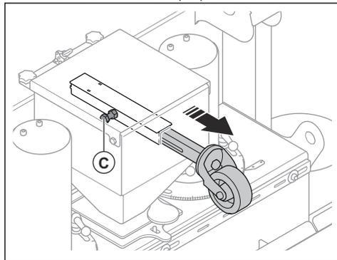
4. キャスターの位置を表面から 10~20 mm (0.4~0.8 インチ) に調整し、ボルトを締めます。
