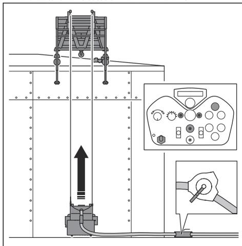
6. リモートコントロールのディスプレイでアンペア数の値を読み取り、2つのプラストホイールにかかる負荷が等しいことを確認します。必要に応じて負荷を調整します。参照：研磨材用バルブの操作方法 57 ページ。
