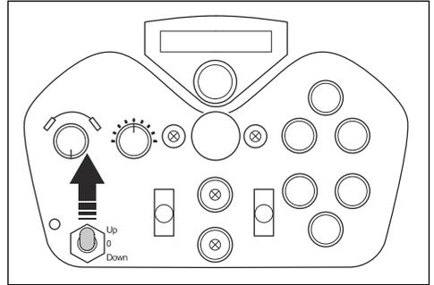
4. リミットスイッチを押し下げます。ウィンチが停止します。
