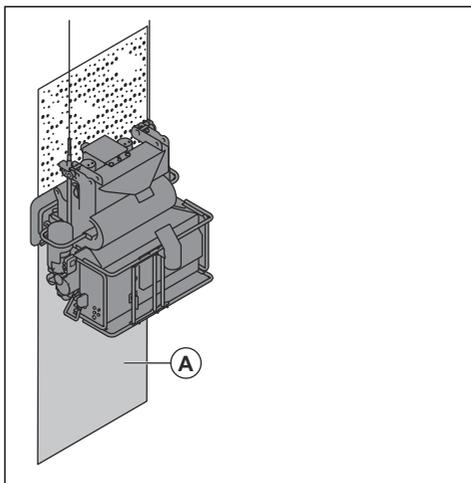
良好な結果を得るには、ホットスポットを表面で均等に適用する必要があります。ホットスポットが正しくない場合は、コントロールケージを回します。参照：ブラストパターンの調整方法 66 ページ。
