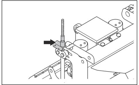
当产品位于钢丝绳顶端时，限位开关可防止产品和索具系统损坏。如果启用了限位开关，则上移操作将停止，并且只能下移产品。
