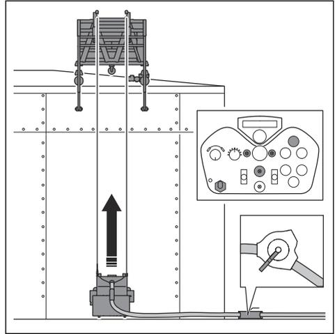
6. 读取遥控器显示屏上的安培值，并确保 2 个抛丸轮上的负载相等。必要时调整负载。请参阅 操作磨料阀门 在第 143 页上。
