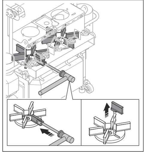
a) 将工具放在抛丸轮叶片的最低位置。
