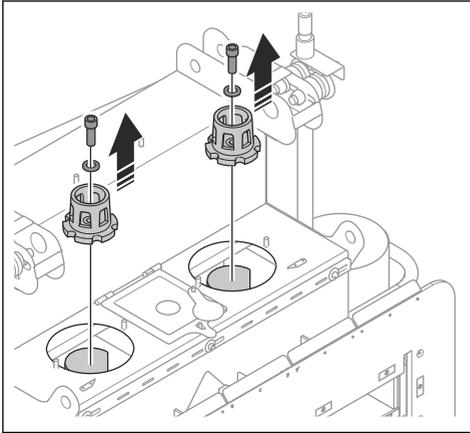
5. 拆下 6 个抛丸轮叶片。对每个叶片执行以下步骤：
