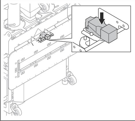
接近开关检测产品是否紧贴表面。如果产品在操作过程中从表面脱离，则接近开关会立即关闭磨料阀门。
