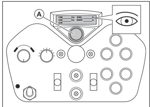
4. 「Radio Error (無線エラー)」というメッセージが消え、左右のプラストモーターの周波数とアンペア数の値がディスプレイに表示されていることを確認します。ディスプレイの左下に「ON (オン)」というメッセージが表示されます。
