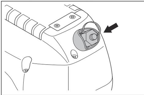
2. CAN バスケーブルのもう一方の端を、電気ボックスのコネクタ (A) に差し込みます。
