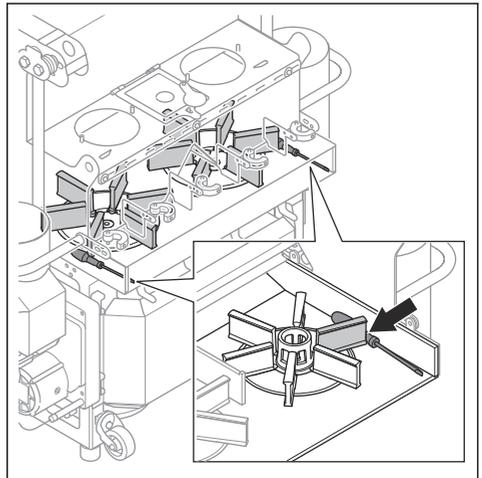
4. ボルトおよびインペラを取り外します。ボルトを廃棄します。
