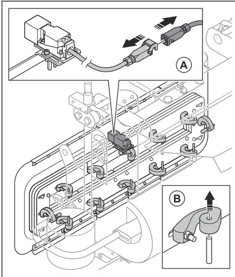
2. 拆下 12 个橡胶弹簧 (B)。
