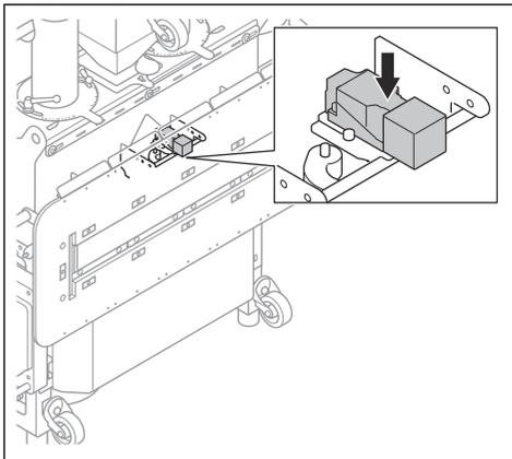
近接スイッチは、製品が表面に接触しているかどうかを検知します。動作中に製品が表面から離れると、近接スイッチは研磨材用バルブをただちに閉じます。
