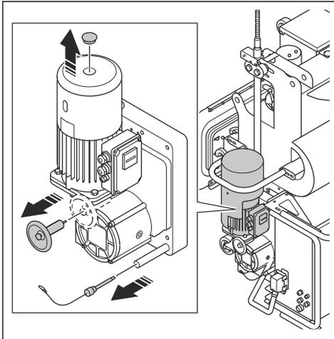
2. ハンドルを穴に通してモーターシャフトに取り付けます。モーターハウジングの開口部を通してレバーをブレーキのプラケットに押し込みます。
