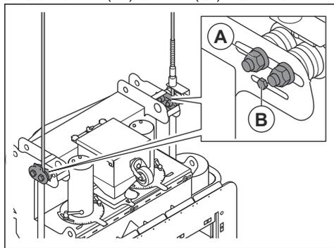
3. 研磨材シールが表面と平行になるまで緩めたローラーを調整し、ナットとボルトを締めます。
