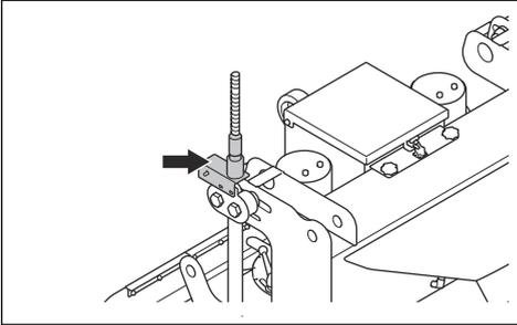
リミットスイッチは、製品がスチールワイヤーロープの上部にあるときに、製品とリグシステムの損傷を防ぎます。リミットスイッチが作動すると、上昇動作が停止し、製品を下降させることができます。
