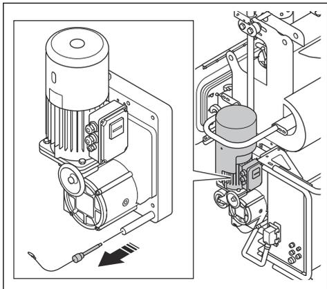
2. 推动制动器释放杆穿过电机壳体中的开口，推到制动器上的支架上。
