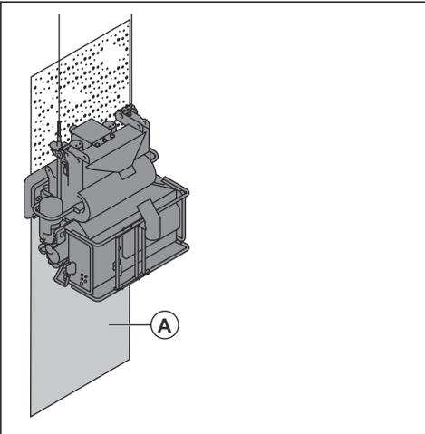
要获得良好的效果，必须在表面上均匀地施加高温喷丸。如果高温喷丸不正确，请转动控制笼。请参阅 *调整抛丸纹理* 在第 152 页上。
