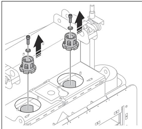
5. 6枚のプラストホイールブレードを取り外します。ブレードごとに次の手順を実行します。
