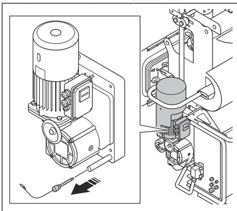
2. ブレーキリリースレバーをモーターハウジングの開ロ部を通してブレーキのブラケットに押し込みます。
