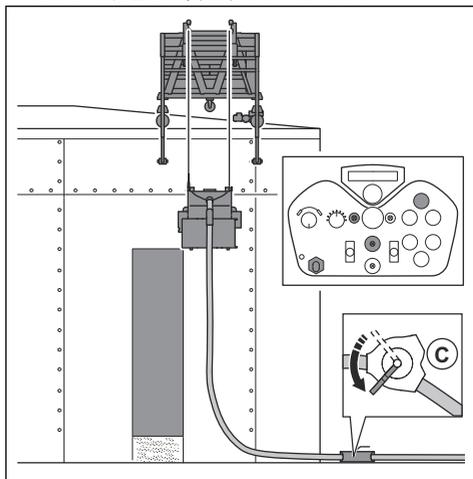
13. 本製品を下に操作し、移動中に研磨材用バルブを開きます。
