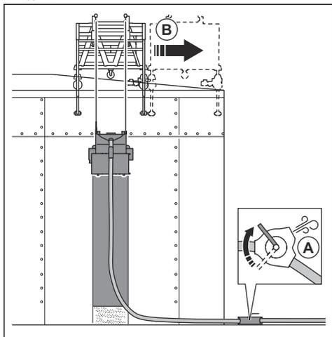
11. 将索具系统 (B) 右移。相关说明请参阅索具系统操作手册。
