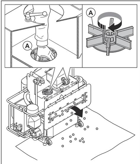
6. バルブのラバーシールに研磨材が付着していないか確認します。参照：研磨材用バルブのラバーシールの交換方法 75 ページ。
