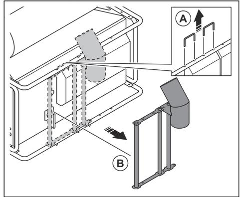
3. 将吸尘软管的支撑管 (B) 倾斜一小段距离，然后将其提起以拆下。
