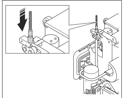
5. リミットスイッチを放します。ウィンチが始動します。
