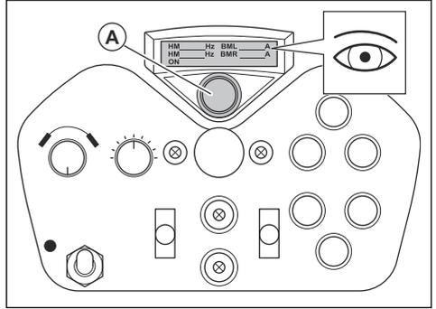
4. "Radio Error(무전기 오류)" 메시지가 사라지고 디스플레이에 왼쪽 및 오른쪽 블래스트 모터의 주파수 및 전류 값이 표시되는지 확인합니다. 디스플레이의 왼쪽 하단에 "ON(켜짐)"이라는 메시지가 표시됩니다.
