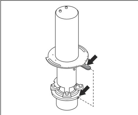
6. コントロールケーシングのノッチがコントロールケーシングリングのノッチと合っていることを確認します。
