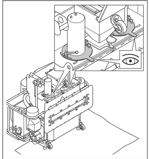
3. 研磨材用バルブを取り外します。参照：研磨材用ホッパーとバルブの取り外しと取り付け方法 73 ページ
