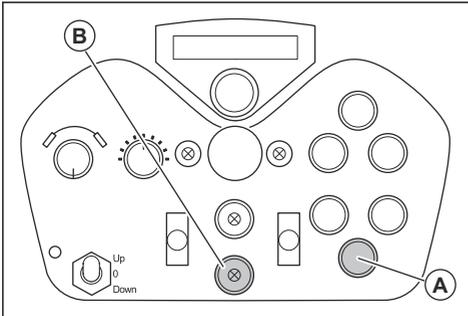
2. ボタン (B) を押して、プラストモーターを停止します。ボタンのインジケータが点灯し、プラストモーターがオフになっていることを示します。
