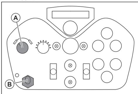
3. リモートコントロールの可動用レバー (B) を前方に押し、ウィンチモーターを始動します。
