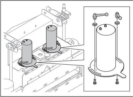
3. 断开磨料阀门的电缆。
