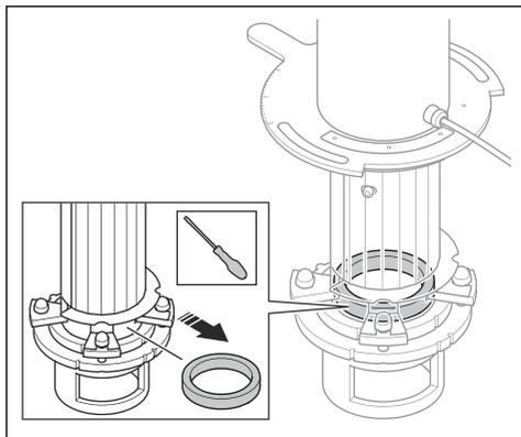
5. コントロールケージ窓の 1 つに新しいラバーシールを取り付けます。
