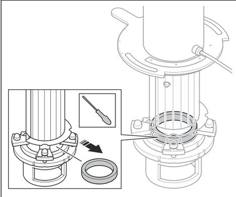
5. 通过控制笼的一个窗口安装新的橡胶密封件。
