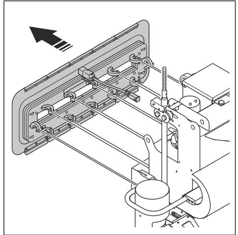
4. 按相反顺序安装新的磨料密封件。
