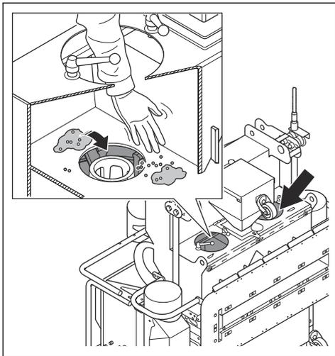
5. プラストホイール (A) を手で回して、研磨材を製品から防水シートの上に押し出します。
