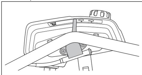
2. Portare il comando dell'acceleratore nella posizione di arresto.
