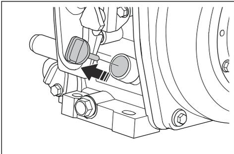
4. Reinscrivere completamente l'asta di livello nel serbatoio dell'olio.
