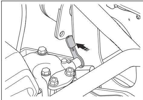
**Nota:** Una volta avviato il motore, la leva di decompressione ritorna nella posizione iniziale.
