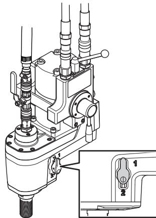
**MERKNAD!** Det er bare mulig å skifte mekanisk gir når maskinen er slått av. Ellers kan det føre til fare for skade på girkassen.
