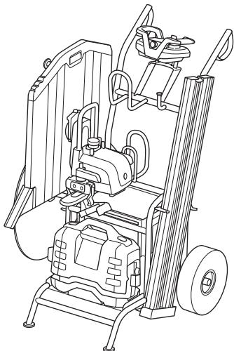
作業を実行するためのソーイングシステム一式は付属のコンパクト搬送トロリーに保管されていて、以下の内容で構成されています。
