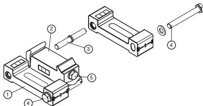
为了更容易操作锁定螺钉以调节角度 (4) 和/或操作锁定螺钉调整锁紧垫片 (5)，墙装托架可相互对称。
