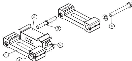
角度調整用ロックネジ(4)および／またはクランピングワッシャーロックネジ(5)へのアクセスを良くするため、壁プラケットは二重化できます。
