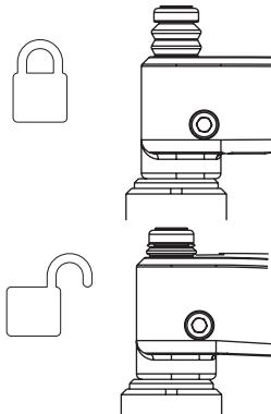
如果锯设备安装在垂直安装的钢轨上，则应当先锁定上部锁柄，因为一旦锁定则锯子的重量得到释放更易于锁定下部锁柄。确保锯子与引导轮和钢轨之间无松动。如果存在松动，则必须调整引导轮。参见“调整引导轮”部分。
