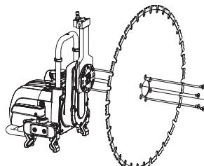
Điều chỉnh khoảng cách của giá đỡ trên tường so với đường cắt ở khoảng 85-90 mm tính từ đường cắt trong khi lắp đặt cho đường cắt thẳng. Phải dùng hàm bảo vệ lưỡi cắt thẳng riêng cho đường cắt thẳng.
