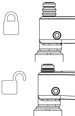
ソーイングユニットが垂直取り付けレールに取り付けられている場合、上のロックハンドルをロックすると、ソーの重量がかからなくなり、下のハンドルを簡単にロックできるので、上からロックします。ソーのガイドホイールとレールの間に遊びがないことを確認します。遊びがある場合は、ガイドホイールを調整する必要があります。「Adjustment of guide wheels(ガイドホイールの調整)」をご覧ください。
