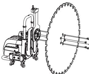
平面切断向けに組み立てるときに、切断ラインから壁ブラケットの切断ラインまでの距離が約85~90 mmになるように調整します。平面切削を行う場合には、特別な平面カッティングブレードガードを使用する必要があります。
