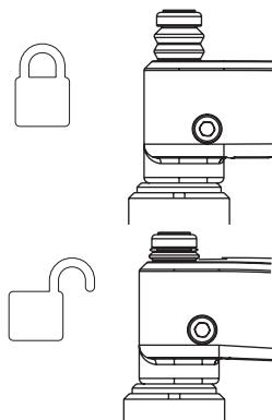
Nếu máy cắt được lắp trên thanh ray thẳng đứng, nên bắt đầu bằng cách khóa tay chốt phía trên vì khi đã khóa tay chốt đó lại, trọng lượng máy cắt được giảm bớt và sẽ dễ khóa tay chốt bên dưới hơn. Đàm bảo máy cắt không có khe hở nào giữa các bánh dẫn hướng và thanh ray. Nếu có khe hở thì phải điều chỉnh các bánh dẫn hướng. Xem phần 'Điều chỉnh bánh dẫn hướng'.
