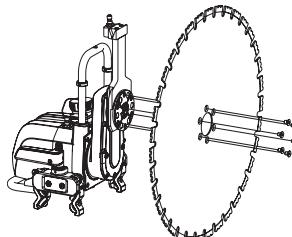
在安装平头切削时，将墙上支架与切割线之间的调整至约 85-90 mm。应对平头切削使用特殊的平头切割锯片防护罩。
