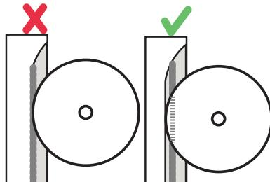
壁がブレードの最大深さより薄い場合、壁を貫通したら、ブレードができる限り深く入れるほうが有利です。このようにすると、切断面が減少し、ブレードのセグメントにかかる圧力が増します。また、切断後に残る「クサビ」が小さくなるため、オーバーカットできない場合もこの方法で作業すると有利です。
