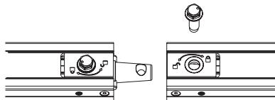
完成したレールの一方の端には、固定されたエンドストップがあります。もう一方の端には、図のように締められていないエンドストップが取り付けられています。ストップは、スライスコネクタと同じ方法で、傍心ボルトを使用してロックされています。
