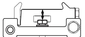
各壁プラケットと切断ラインは80 mm (3.15インチ) にします。切断ラインが正確に垂直または水平な場合で、サポート面が平らである場合、壁プラケットのアルコール水準器を使用して、この早い段階で正確に調整し、その後でエキスパンダーボルトを40 Nmで締めます。レールを壁プラケットに取り付けるまで待ってエキスパンダーボルトを締める必要がある場合もあります。
