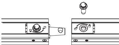
在整条钢轨的一端有一个固定的末端止动器。在另一端按照说明安装一个松动的末端止动器。该止动器使用外心螺栓，以与绞合接头相同的方式锁固。
