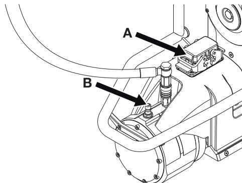
Quando o cabo de alimentação está ligado à serra, o mosquetão do cabo deve estar preso à unidade de serra para prevenir tensões na ligação durante a operação. O mosquetão deve ser preso a um dos olhais da barra do guiador que está aparafusada à retaguarda do motor de condução.
