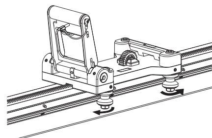
Houd de 16 mm sleutel in positie terwijl u de twee aanslagschroeven vastdraait met een 3 mm inbussleutel.
