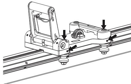
Rodar os eixos suavemente com uma chave inglesa de 16 mm até que as rodas de guia se encostem ao carril.
