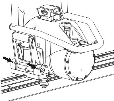
Accertarsi che l'impugnatura di bloccaggio sia regolata correttamente, aprendo e chiudendo; verificare che il blocco a molla sia in posizione bloccata.
