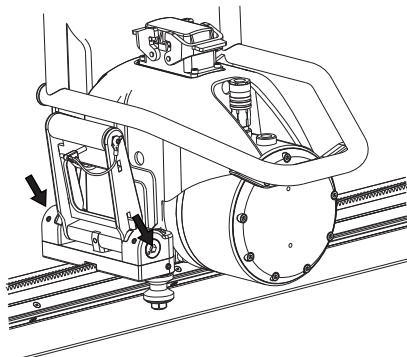
Apertar os dois parafusos de bloqueio com uma chave sextavada interior (chave allen) de 3 mm.
