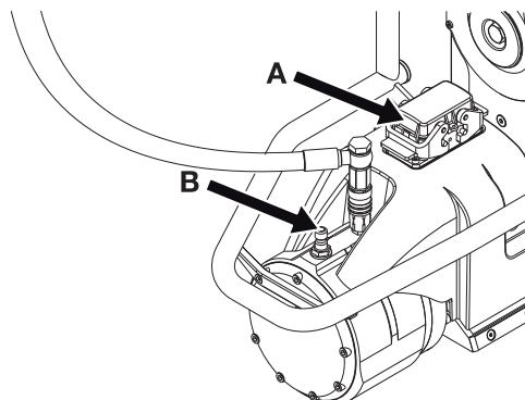
Nadat de voedingskabel op de zaag is aangesloten, moet de karabijnhaak op de kabel aan de zaag worden bevestigd om druk op de stekker tijdens bedrijf te voorkomen. De karabijnhaak moet worden vastgemaakt aan een van de steunogen op de handgreep die op de achterzijde van de aandrijfmotor is geschroefd.
