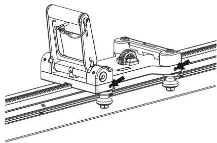
Pressionar o dispositivo de bloqueio e puxar à mão o transporte da serra nas duas direcções. O transporte deve deslizar facilmente com uma leve resistência. Todas as 4 rodas de guia devem rodar.
