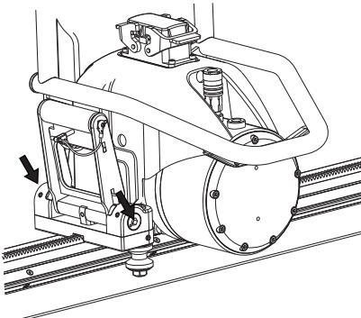
Serrare le due viti di arresto con una chiave a brugola da 3 mm.
