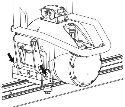
Draai de twee aanslagschroeven vast met een 3 mm inbussleutel.
