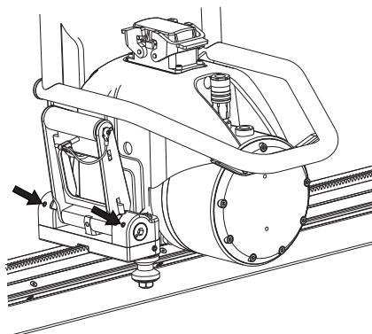
Rodar as duas mangas excêntricas com uma chave sextavada interior (chave allen) de 8 mm até que o eixo esteja apertado e paralelo relativamente à unidade de serra.
