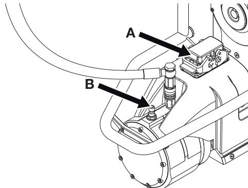
Dopo aver collegato il cavo di alimentazione alla tagliamuri, il moschettone del cavo deve essere collegato al gruppo di taglio per evitare pressioni sulla spina durante il funzionamento. Fissare il moschettone a una delle asole della staffa posta sull'impugnatura avvitata sul retro del motore di azionamento.
