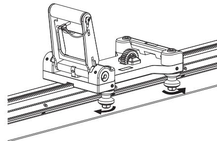
Tenere in posizione la chiave da 16 mm e serrare le due viti di arresto con una chiave a brugola da 3 mm.
