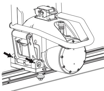
Certifique-se de que o punho de bloqueio está devidamente ajustado, abrindo e fechando e verificando se a mola de fecho está na posição fechada.
