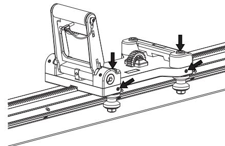
Ruotare delicatamente gli alberi con una chiave da 16 mm fino a quando le ruote guida si appoggiano alla rotaia.
