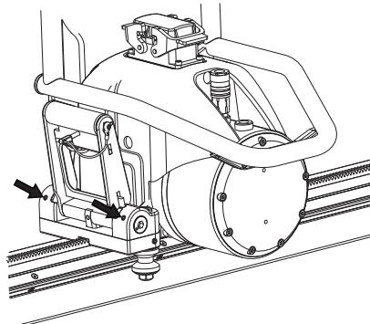
Verzeker u ervan dat de borghandgreep correct is afgesteld door deze te openen en te sluiten en controleer of de veersluiting in de vergrendelde stand staat.
