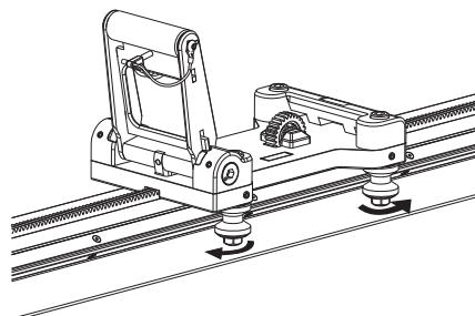
Manter em posição a chave de 16 mm e apertar os dois parafusos de bloqueio com uma chave sextavada interior (chave allen) de 3 mm.
