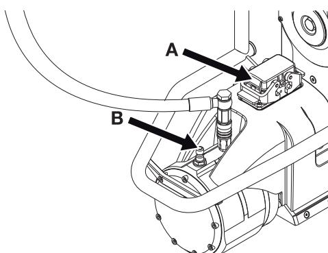
Όταν το καλώδιο τροφοδοσίας συνδεθεί στο πριόνι, το καραμπίνερ στο καλώδιο πρέπει να στερεωθεί στο πριόνι για την αποφυγή άσκησης πίεσης στο φίς κατά τη λειτουργία. Το καραμπίνερ πρέπει να στερεωθεί σε μία από τις οπές βραχίονα στη λαβή που είναι βιδωμένη στο πίσω μέρος του κινητήρα.
