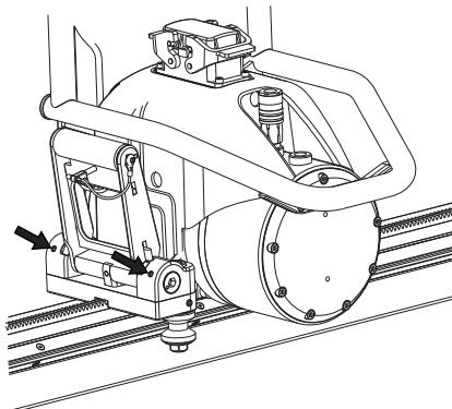
Draai de twee excentrische bussen met een 8 mm inbussleutel totdat de as stevig vastzit en parallel met de zaagunit is.
