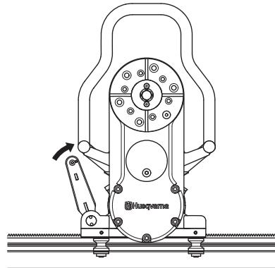
**AVVERTENZA!** Il taglio con la mototroncatrice non correttamente fissata a carrello di taglio e rotaia comporta pericolo di morte.
