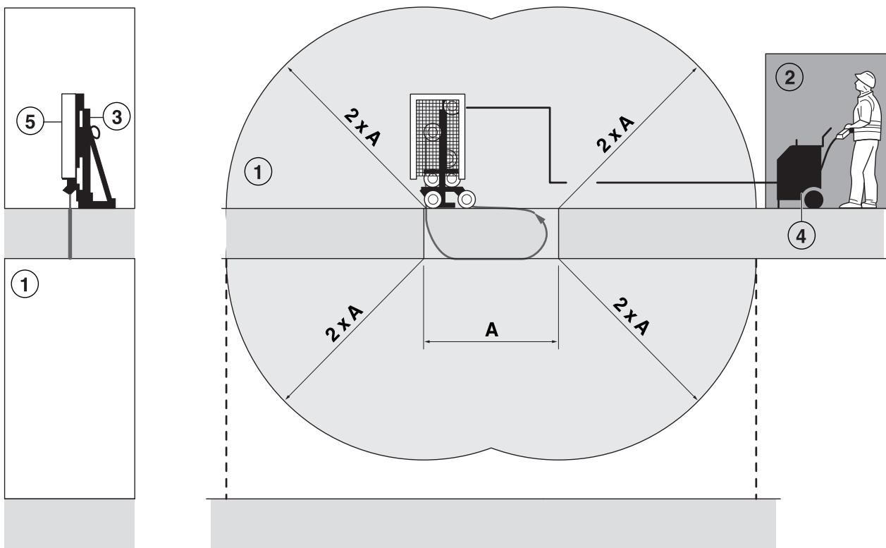
(A) Найбільша частина дроту під час холостого ходу
