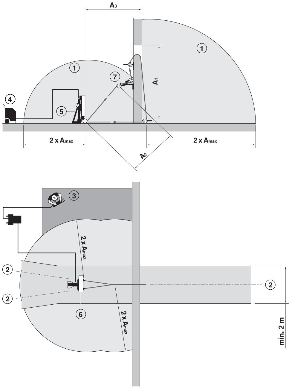
( $A_{\max}$ ) Найбільша частина дроту під час холостого ходу ( $A_1-A_3$ )
