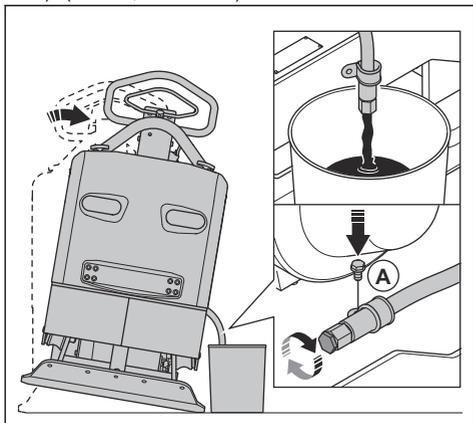
7. Rabboccare con olio motore nuovo. Fare riferimento al manuale del motore per informazioni sul tipo di olio motore corretto.
