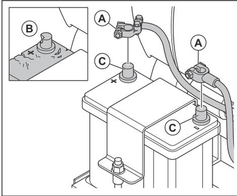
2. Controllare la presenza di eventuali danni alla batteria (B). Sostituire la batteria se danneggiata.
