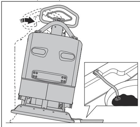
**Nota:** È inoltre possibile utilizzare una pompa di scarico dell'olio manuale per scaricare l'olio nell'elemento eccentrico.
