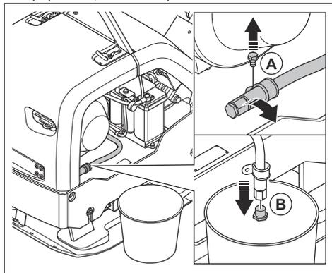
2. Collocare un contenitore sotto il tubo flessibile di scarico dell'olio.
