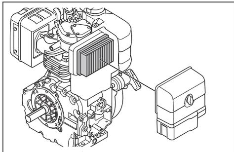
3. Pulire l'alloggiamento del filtro dell'aria con una spazzola.
