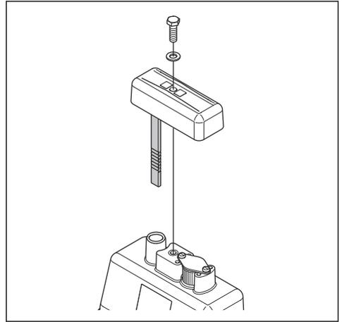
2. Leggere il livello dell'olio idraulico sull'asta di livello.
