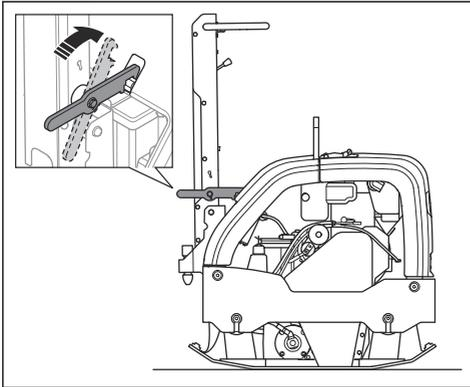
2. Befestigen Sie die Hebevorrichtung an der Hebeöse.
