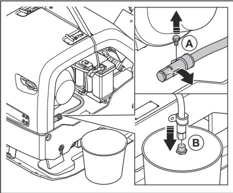
2. Stellen Sie einen Behälter unter den Ölablassschlauch.
