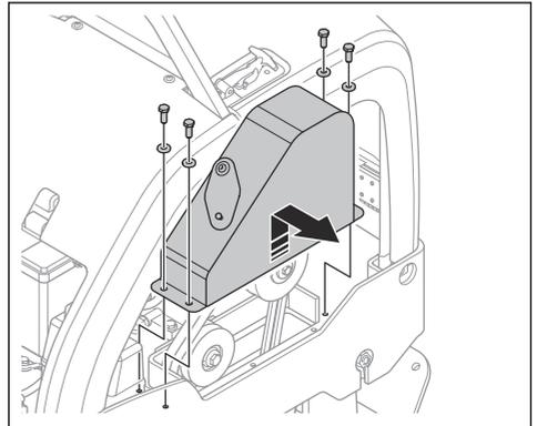
3. Überprüfen Sie den Keilriemen auf Beschädigung und Verschleiß. Ersetzen Sie den Keilriemen bei Bedarf.
