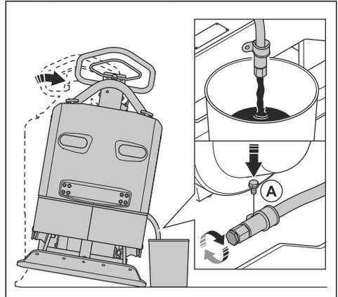
7. Füllen Sie neues Motoröl ein. Die richtige Motorölsorte können Sie der Motor-Betriebsanleitung entnehmen.
