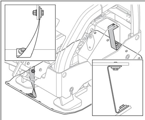
2. Prüfen Sie die Schrauben und Muttern an den Sicherheitsschlaufen.
