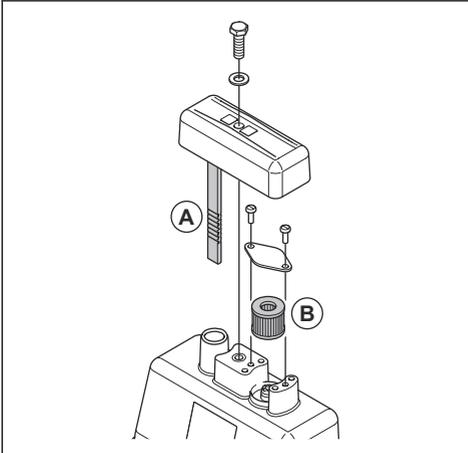
2. Verwenden Sie eine Ölablasspumpe, um das Hydrauliköl aus dem Hydrauliköltank abzulassen.
