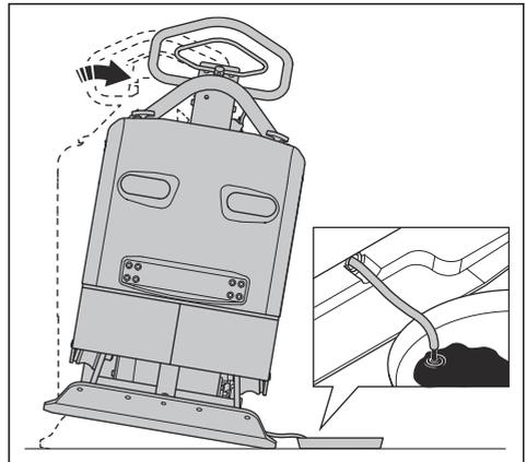
**Hinweis:** Sie können auch eine manuelle Ölablasspumpe verwenden, um das Öl im Exzenterelement abzulassen.
