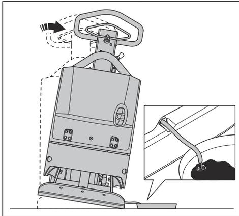
**Remarque:** il est également possible d'utiliser une pompe manuelle de vidange d'huile pour vidanger l'huile de l'élément excentrique.
