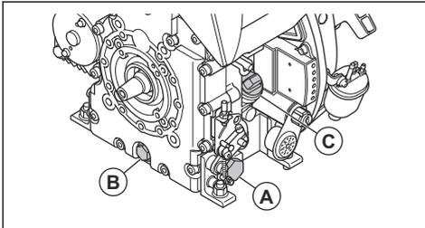
2. Déposez le bouchon de vidange d'huile (A) ou (B) et branchez un flexible.
