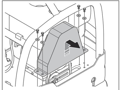
3. Vérifiez l'absence de dommages et de défauts au niveau de la courroie trapézoïdale. Remplacez la courroie trapézoïdale si nécessaire.
