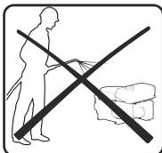
Não limpe o motor com uma máquina de lavar de alta pressão.
