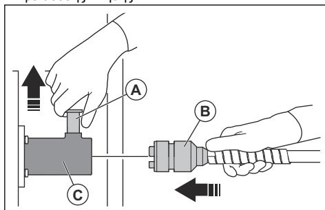
2. Τοποθετήστε τον σύνδεσμο του εύκαμπτου άξονα (B) μέσα στον σύνδεσμο της μονάδας μετάδοσης κίνησης (C).
