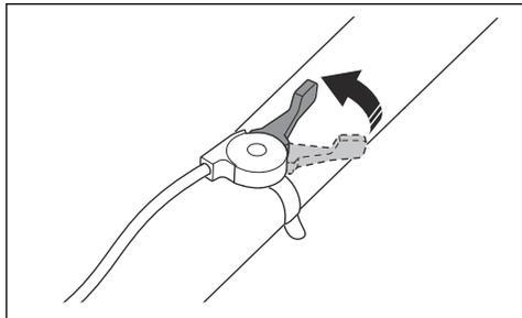
3. Poussez la pompe d'amorçage jusqu'à ce que du carburant apparaisse dans le tuyau de carburant.
