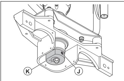
4. Завъртете ексцентричния елемент (K), за да регулирате тежестта. В таблицата по-долу е показано колко трябва да се завърти ексцентричният елемент при различни греди и при различна консистенция на бетона. Върху ексцентричния елемент има 4 маркировки – 62%, 75%, 87% и 100%.
