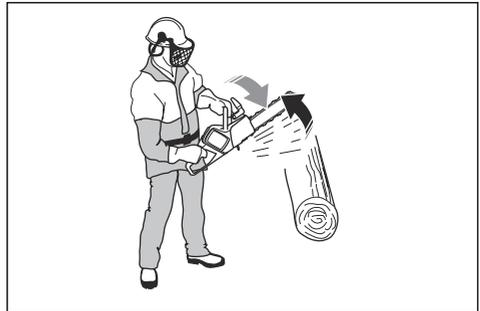
Utiliser le frein de chaîne en tant que frein de stationnement lors du démarrage du produit ou de déplacement sur de courtes distances. Cela réduit le risque de contact avec la chaîne pour vous et les personnes qui vous entourent.
