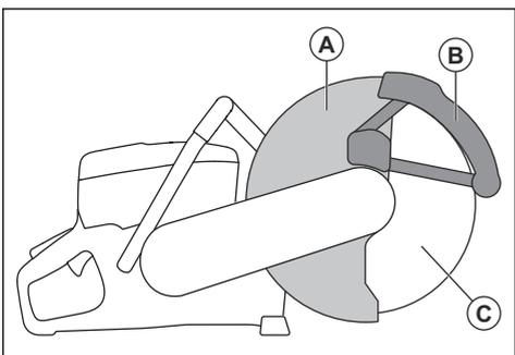
SmartGuard є підпружиненим елементом, який має завжди рухатися вільно та повертатися в початкове положення під дією пружини.
