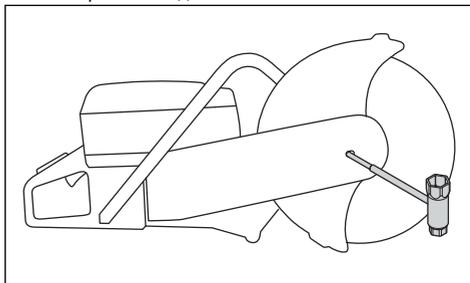
2. Послабте два болти, а потім установлювальний гвинт, щоб послабити пас.
