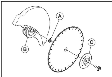
4. Поставете инструмент в отвора на защитата на предния ремък и завъртете режещия диск, докато валът се фиксира.
