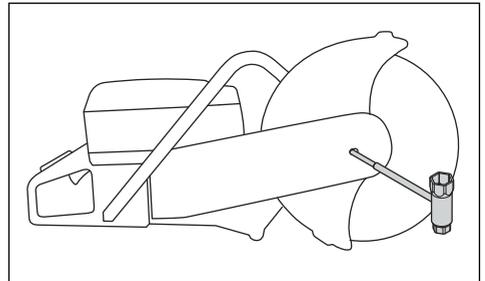
5. Затягніть болт різального диска з моментом 25 Н·м / 18,5 футів-фунт.
