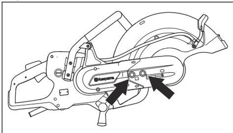
2. Rotiți șuruburile de reglare până când piulița de reglare se află în partea opusă marcajului de pe capacul curelei de transmisie.
