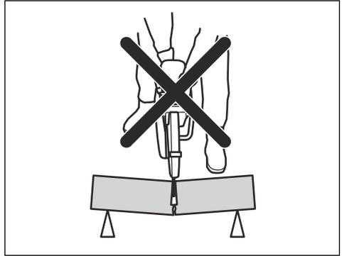
Якщо різець є затиснутим або заклинений у зоні віддачі, реактивна сила штовхне бензоріз в обертovому русі наверх та назад, вбік користувача, що може призвести до тяжких і навіть смертельних травм. Ураховуйте можливе зсування оброблюваного предмета. Якщо оброблюваний предмет не закріплено належним чином і зміщується під час різання, він може затиснути лезо та спричинити віддачу.
