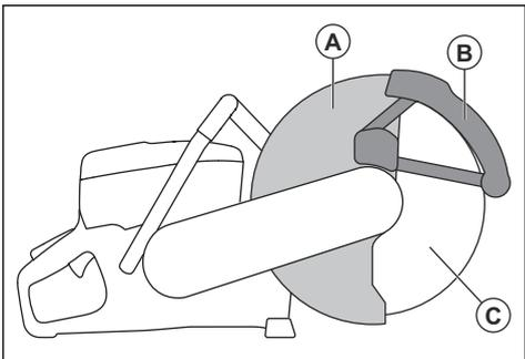
SmartGuard е пружинно натегнат и винаги трябва да се движи свободно и да се връща в първоначалното си положение под действието на пружинната сила.
