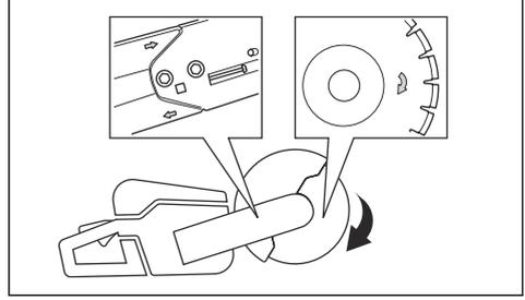
2. Kesim bıçağı üzerindeki kesim bıçağının dönme yönünü gösteren oku bulun.
