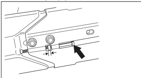
3. За допомогою комбінованого гайкового ключа затягніть 2 болти, що втримують різальну головку на виробі.
