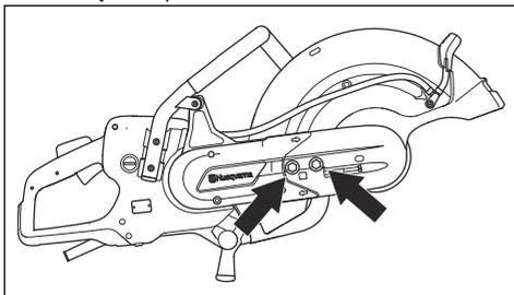
2. Поверніть регулювальні гвинти таким чином, щоб регулювальна гайка була розташована навпроти позначки на кришці приводного паса.
