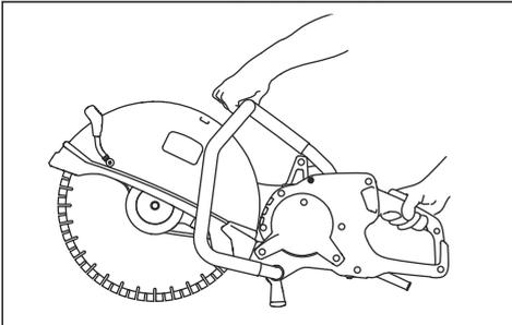
2. Натисніть фіксатор механічного пускового пристрою та утримуйте пусковий пристрій.
