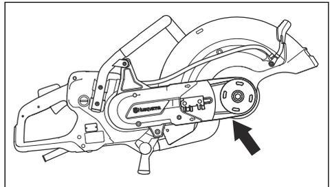
6. Поверніть коробку підшипника в протилежному напрямку та зберіть стопор.
