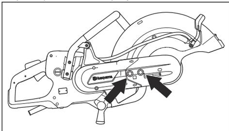
2. Завъртете винтовете за регулиране, докато гайката за регулиране е обратно на маркировката на капака на задвижващия ремък.
