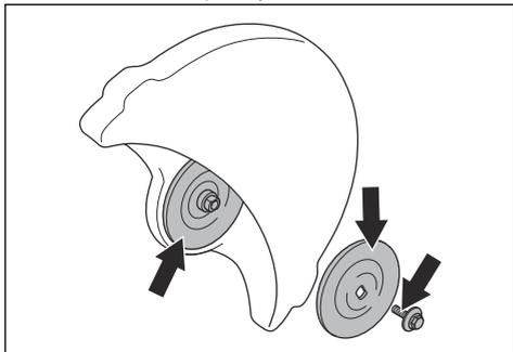
2. Asigurați-vă că zonele de contact de pe disc și șabilele nu sunt deteriorate. Înlocuiți componentele deteriorate.
