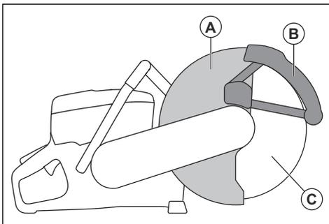
SmartGuard este tensionat cu arc și trebuie întotdeauna să se deplaseze liber și să se retragă în poziția inițială sub acțiunea forței elastice.
