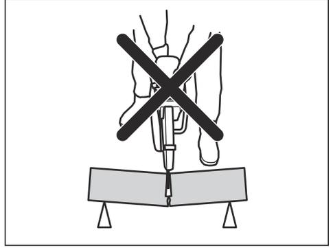
Bıçak geri tepme bölgesinde sıkıştırsa veya duraklarsa, reaktif kuvvet, el tipi kesiciyi yukarı ve geriye, kullanıcıya doğru döner bir hareketle iterek ciddi, hatta ölümcül yaralanmaya neden olabilir. Çalışma parçasının hareket etmesi olasılığına karşı dikkatli olun. Çalışma parçası doğru desteklenmiyorsa ve kesme işlemi sırasında kayarsa, bıçağı sıkıştırabilir ve geri tepmeye neden olabilir.
