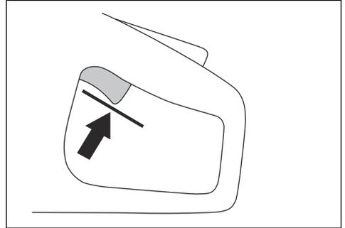
2. Apăsați pe opritorul întrerupătorului și asigurați-vă că revine în poziție atunci când îl eliberați.
