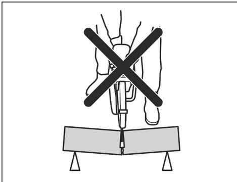
Dacă lama este prinsă sau blocată în zona de recul, forța de reacție va împinge motoferăstrăul în sus și înapoi spre operator, într-o mișcare de rotație, cauzând vătămări corporale grave sau chiar mortale. Fiți atent la o potențială mișcare a piesei de lucru. Dacă piesa de lucru nu este corect susținută și se mișcă în timpul tăierii, aceasta poate intra în contact cu lama și poate cauza recul.
