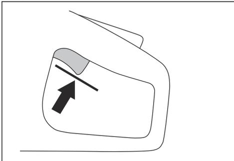
2. Натисніть на фіксатор механічного пускового пристрою та переконайтеся, що він повертається у вихідне положення, коли ви відпускаєте його.
