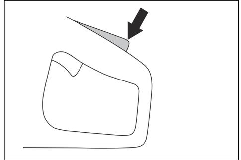
3. Asigurați-vă că întrerupătorul și opritorul întrerupătorului se mișcă liber și că arcul de rapel funcționează corect.
