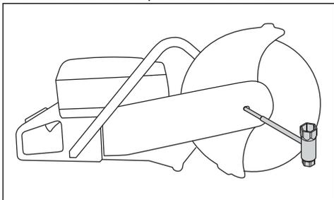
2. Slăbiți cele 2 șuruburi și apoi șurubul de reglare, pentru a detensiona cureaua.
