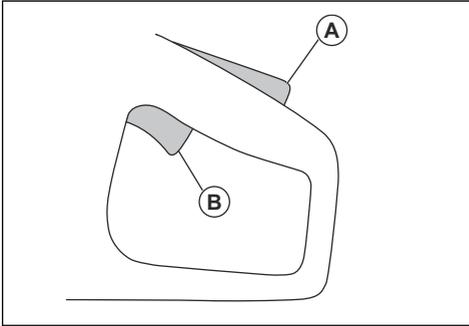
Коли ви випускаєте ручку з рук, фіксатор і механічний пусковий пристрій повертаються до вихідного положення. Ця функція блокує механічний пусковий пристрій і зупиняє виріб. Водяний клапан повертається в закрите положення.
