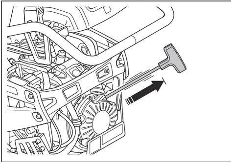
5. Αφήστε τη λαβή του σχοινιού εκκίνησης, μέχρι το κορδόνι του συστήματος εκκίνησης να τυλιχτεί πίσω.
