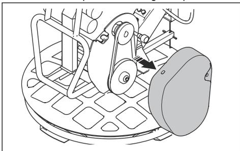
3. Controllare se la cinghia trapezoidale (A) presenta danni e usura. Sostituire la cinghia trapezoidale, se necessario.
