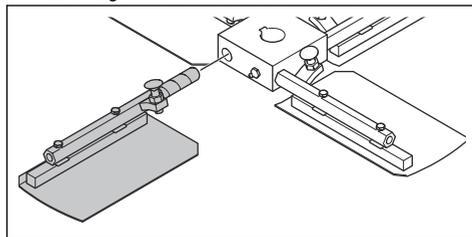
4. Sostituire gli alberi delle lame danneggiati.
