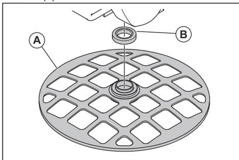
5. Pulire le superfici di tutte le parti e lubrificarle con cautela. Sostituire le parti danneggiate.
