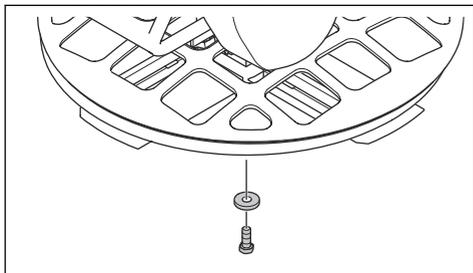
2. Rimuovere il complessivo lama. Utilizzare un estrattore se il complessivo lama non è facilmente rimovibile.
