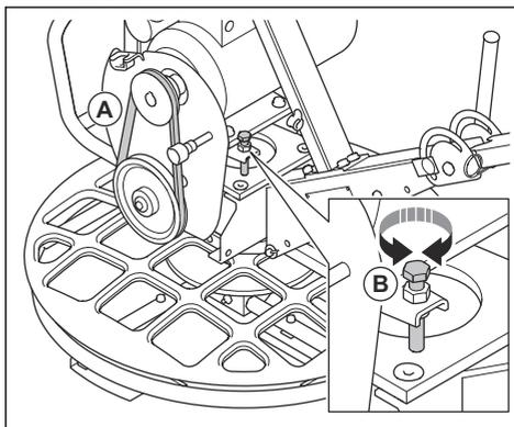
4. Controllare il tensionamento della cinghia trapezoidale.
