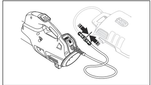
2. Fissare il cavo batteria negli accessori sull'imbracatura.
