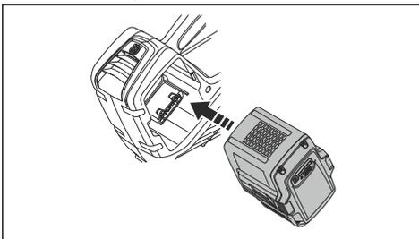
3. Premere sulla parte inferiore della batteria e spingere verso l'interno fino a inserirla nel vano batterie. La batteria si blocca in posizione quando si percepisce un clic.
