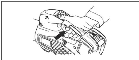
2. Premere il pulsante di controllo della velocità per impostare il flusso d'aria prescelto, il LED si accende.
