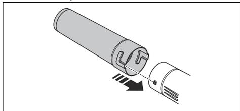
2. Spingere completamente l'ugello del soffiatore e ruotare l'ugello del soffiatore per bloccarlo al prodotto.
