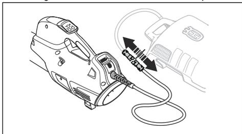
**Nota:** Se la batteria a zaino non viene utilizzata per più di 30 minuti, essa si spegne automaticamente. Per avviare la batteria a zaino, premere nuovamente il pulsante di avvio sulla batteria a zaino.
