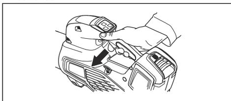
4. Premere di nuovo il pulsante di controllo della velocità per disattivare la funzione di controllo della velocità.
