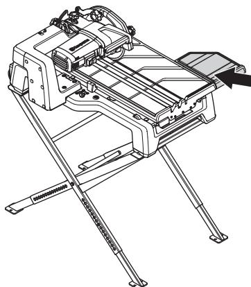
Si la mesa lateral no está al mismo nivel que el carro de transporte, necesita un ajuste. Utilice para ello los tornillos.
