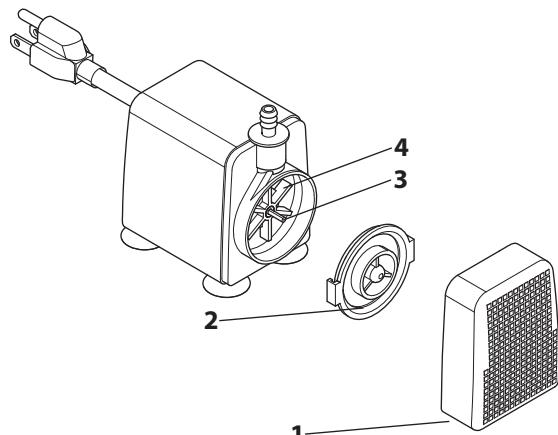
Utilizzare un panno per rimuovere le particelle di ferro che potrebbero aderire all'albero rotore magnetico.
