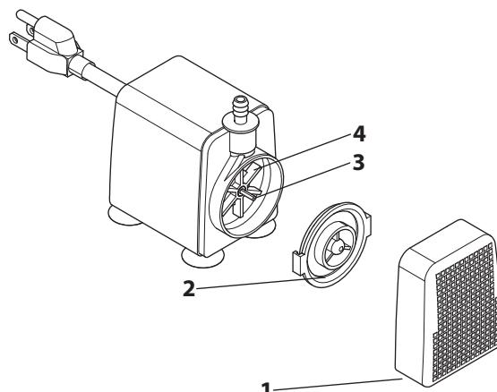
Poderá utilizar um pano para remover partículas de ferro que tenham aderido ao eixo do rotor magnético.
