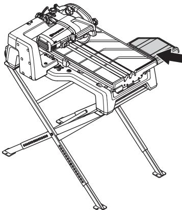
Se la mensola laterale non è alla stessa altezza del carrello trasportatore, può essere necessaria una regolazione. Regolare usando le viti.
