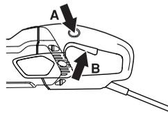
El bloqueador de interruptor permanece presionado mientras está presionado el interruptor. Cuando se suelta la empuñadura, se restablece el interruptor y el bloqueador de interruptor. Esto se hace con dos sistemas de muelle de retorno independientes. Con esta posición, la máquina se para y se bloquea el interruptor.
