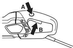
Le blocage de l'interrupteur reste enfoncé tant que l'interrupteur est enfoncé. Quand la poignée est relâchée, l'interrupteur et le blocage de l'interrupteur reviennent en position initiale. Ce retour s'effectue grâce à deux systèmes de ressorts de rappel indépendants l'un de l'autre. Dans cette position, la machine s'arrête et l'interrupteur se bloque.
