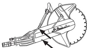
Saque la correa vieja y monte la correa nueva. Arme el brazo de corte con la sección de motor y tense la correa con el tornillo de ajuste. Una correa nueva se debe reajustar después de aproximadamente 30 minutos de funcionamiento.
