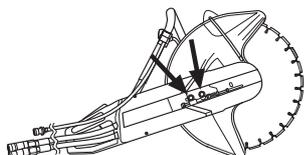
Seguidamente, enrosque el tornillo de ajuste para que la tuerca rectangular quede frente a la marca del envoltorio. Así, la correa recibe automáticamente el tensado correcto.
