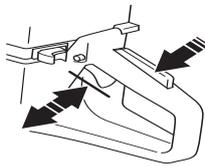
Arranque la máquina, suelte el acelerador y controle que el motor y el disco de corte se paran.
