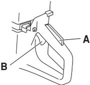
El bloqueador de acelerador permanece en posición interior mientras está presionado el acelerador. Cuando se suelta la empuñadura, el acelerador y el bloqueador de acelerador retornan a la posición inicial. Esto se hace con dos sistemas de muelles de retorno independientes. En esta posición la máquina se para y el acelerador es bloqueado.
