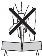
Ha a korong a visszarúgási zónában csípődik be vagy akad el, a gép a reakcióerő hatására forgó mozgással felfelé és hátra dobódik, a felhasználó felé, és így súlyos, akár halálos sérülést is okozhat. Legyen elővigyázatos, ha a munkadarab meghozza. Ha a munkadarab nincs megfelelően megtámasztva, és vágás közben eltolódik, becsípheti a pengét, ami visszarúgást okozhat.
