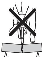
Pokud dojde k zaseknutí kotouče v zóně zpětného rázu, reaktivní síla rozbrúšovací pilu vymrští směrem nahoru a zpět k uživateli rotačním pohybem způsobujícím vážné nebo dokonce smrtelné zranění. Mějte se na pozoru před možným pohybem zpracovávaného dílu. Pokud není zpracovávaný díl řádně podepřen a při řezání se posouvá, může přiskřípnout kotouč a způsobit zpětný ráz.
