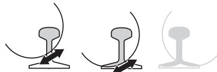
Pokud není možné dokončit řez z jedné strany, musíte rozbrušovací pilu otočit.
