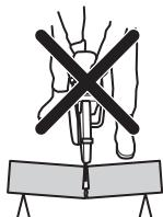
Ak sa kotúč zasekol alebo uviazol v zóne spätného nárazu, reakčná sila rotačným pohybom vyhodí rozbrusovaciu pílu dozadu smerom na používateľa a môže spôsobiť vážne alebo dokonca smrteľné zranenie. Dávajte pozor na potenciálny pohyb obrobku. Ak obrobok nie je pevne podopretý a pri rezaní sa posunie, mohol by zovrieť kotúč a spôsobiť spätný náraz.
