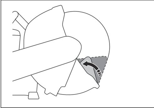
4. ブレードガードを押し込み、スプリングの力で瞬時に元に戻ることを確認します。
