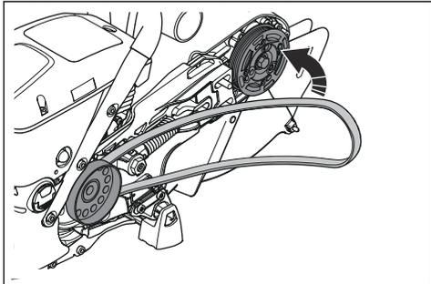
6. 駆動ベルトが正しい位置に取り付けられていることを確認します。
