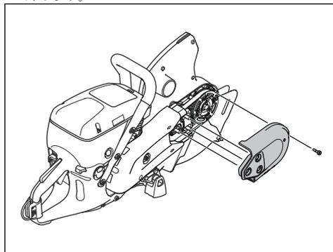
3. リアベルトガードにある2本のネジを外します。ベルトガードを外します。
