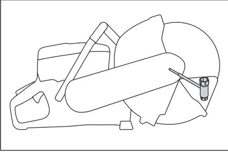
4. ボルトを 30 Nm (18.5 ft-lbs) で締め込みます。
