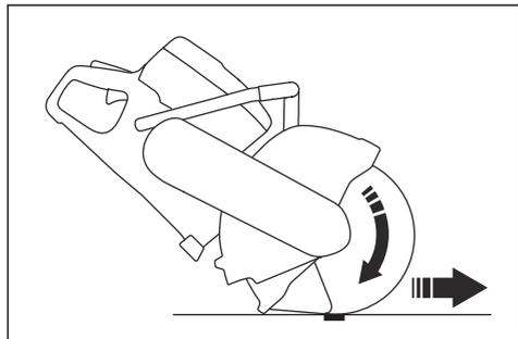
カッティング装置を回転させたまま、本製品を移動しないでください。ジャイロ力により、意図した動きが阻害される場合があります。
