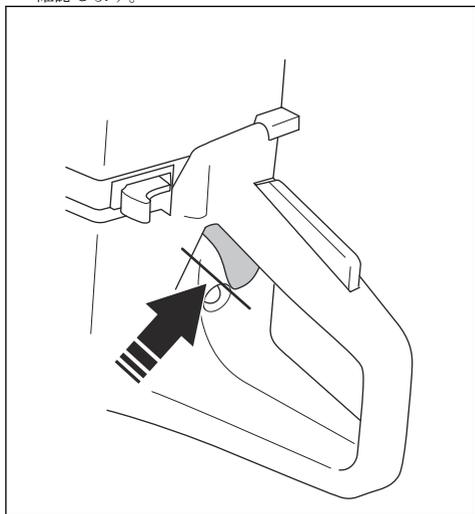
3. スロットルトリガーとスロットルロックがスムーズに動き、リターンスプリングが正しく機能していることを確認します。
