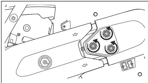
2. ドライブの張りを高めるには、調整ネジを時計方向に回します。
