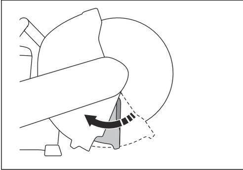
5. カuttingブレードとブレードガードが損傷している場合は交換してください。ブレードガードエクステンダ、ダストシールド、またはそれらのスプリングに欠陥があり、押し込んでも瞬時に元に戻らない場合は、交換してください。
