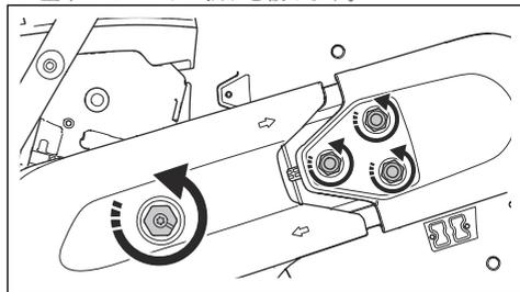
2. ネジとナットを外します。フロントハンドガードを外します。
