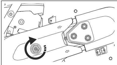
3. ブレードガード (A) を上下に軽く3~5回振ります。ナット (B) を締めます。
