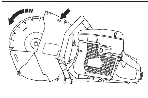
3. ブレードガードの矢印とCuttingブレードの矢印が同じ方向を示していることを確認します。
