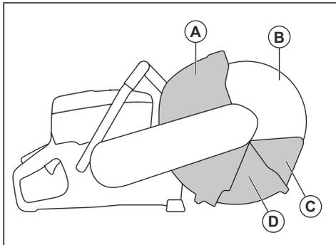
2. ブレードガード (A)、ブレードガードエクステンダ (D)、およびダストシールド (C) に亀裂や他の損傷がないことを確認します。
