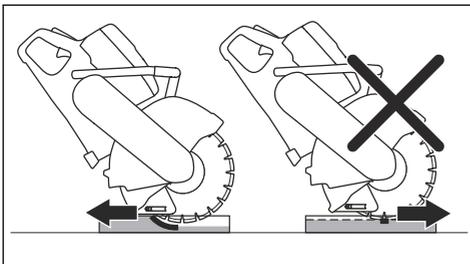
カッティングブレードを切断物の上方/前方で切断深度いっぱいまで押し込み、カッティングブレードを下方/後方にゆっくり移動します。これにより、
