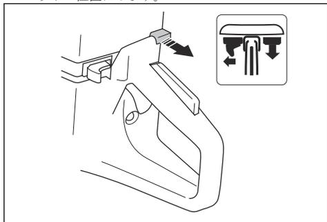
3. 減圧バルブを押して、シリンダー内の圧力を下げます。本製品が始動すると、減圧バルブは初期位置に戻ります。
