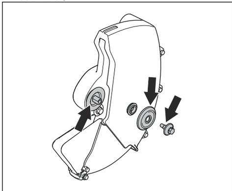
2. カuttingブレードとフランジワッシャーの接触面が損傷していないことを確認します。
