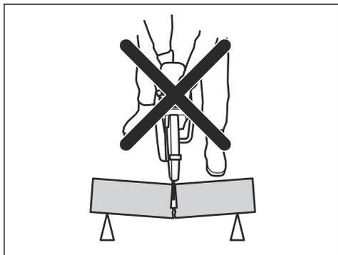
ブレードのキックバックゾーンが挟まったり、引っかかたりすると、反作用力により、作業者に向かってパワーカッターが回転しながら飛ばされて、人命にかかわるような事故が発生することがあります。作業対象物が動く可能性があるため、注意してください。作業対象物がしっかりと保持されておらず、切断時に動くと、ブレードが挟まり、キックバックの原因になる可能性があります。
