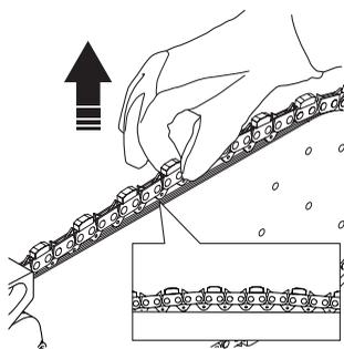
Solte o parafuso da arruela de fixação a partir da parte de trás com uma chave T de 13 mm. Utilize o manipulador de regulação para colocar a corrente em tensão.
