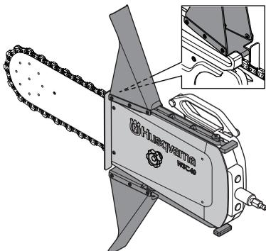
A cobertura e a proteção contra salpicos impedem o contacto com peças em movimento e projeções de detritos, águas e lamas de betão. As proteções de spray também foram concebidas para prender a corrente de diamante caso esta quebre ou se solte.
