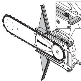
Recomendamos que ambas as proteções para cortes nivelados estejam montadas, mas em algumas aplicações (cortes alinhados com o chão ou com o teto) pode remover-se temporariamente uma das proteções. Pelo menos a proteção no sentido da corrente tem de estar montada. Substitua a proteção após o corte.
