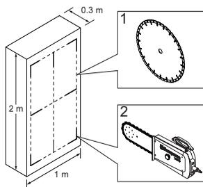
Τροφοδοτήστε τη λεπίδα 3-7 εκατοστά (1,2'-2,8'). Κάντε δοκιμαστική κοπή, προκειμένου να επιτευχθεί μια ευθεία κοπή και με αυτόν τον τρόπο μια βάση για την επόμενη κοπή. Η κοπή θα πρέπει να γίνει με προσοχή. Ο βραχίονας κοπής επιτρέπει τη χρήση αρχικών λεπίδων έως 1.000 χιλιοστών (40'). Συνιστάται, ωστόσο, να ξεκινήσετε την κοπή με λεπίδα 800 χιλιοστών (31,5').
