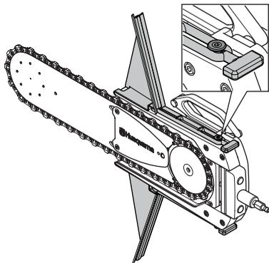
Συνιστούμε να τοποθετούνται και οι δύο προφυλακτήρες επίπεδης κοπής. Ωστόσο, σε μερικές εφαρμογές (ευθυγραμμισμένες κοπές σε δάπεδο ή οροφή), μπορεί να αφαιρεθεί προσωρινά ο ένας. Πρέπει να τοποθετείται τουλάχιστον ο προφυλακτήρας στην κατεύθυνση της αλυσίδας. Αντικαταστήστε τον προφυλακτήρα μετά την κοπή.
