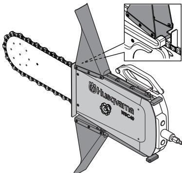
La cubierta y la protección antisalpicaduras evitan el contacto con las piezas móviles y protegen contra los residuos que salen despedidos, el agua y el barro producido por el hormigón. Las protecciones antisalpicaduras también están diseñadas para recoger la cadena de diamante si esta se rompe o se sale.
