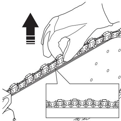
Χαλαρώστε τη βίδα για τη ροδέλα σύσφιξης από το πίσω μέρος, με τη βοήθεια ενός κλειδιού t-box 13 χιλιοστών. Χρησιμοποιήστε το κουμπί ρύθμισης για να τεντώσετε την αλυσίδα.
