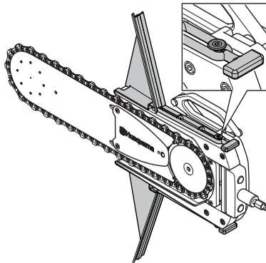
Compruebe las protecciones para ver si presentan desperfectos o desgaste. Asegúrese de que no las protecciones no estén dañadas. Sustituya las protecciones si están dañadas.
