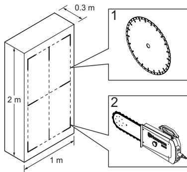
Empurre a lâmina 3 a 7 cm (1,2'-2,8'). Faça o corte piloto para obter um corte reto, sendo essa a base para o corte seguinte. O corte deve ser feito com cuidado. O braço de corte admite a utilização de lâminas até 1000 mm (40") como lâminas iniciais. No entanto, é recomendado iniciar o corte com uma lâmina de 800 mm (31,5').
