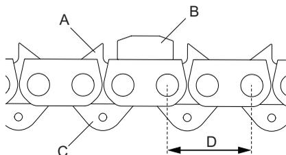
Passo da corrente de diamante:  $\text{Passo} = D/2$
