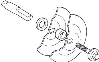
Μεν χρεσιμοποιείτε στραβές, χτυπεμένες ή Βρώμικες ψλάντζες. Μεν χρεσιμοποιείτε ψλάντζες διαψφρετικών διαστάσεων.
