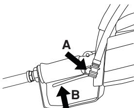
Η ασφάλεια γκαζιού παραμένει πατημένη όσο διάστημα πατιέται και το γκάζι. Οταν αφήσουμε ελεύθερη τη χειρολαβή, επανέρχονται και το γκάζι και η ασφάλεια γκαζιού. Αυτό ρυθμίζεται από δύο μεταξύ τους ανεξάρτητα συστήματα ελατηρίων επαναφοράς. Αυτή η θέση επιφέρει σταμάτημα του μηχανήματος και κλείδωμα του γκαζιού
