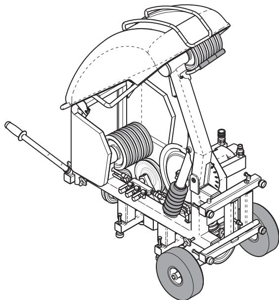
Husqvarna CS 2512 är avsedd att användas tillsammans med hydraulaggregatet PP 455 E eller Husqvarna RC 455. Husqvarna CS 2512 är en kraftfull och lättarbetad wiresåg med kapacitet för riktigt stora jobb, men är samtidigt tillräckligt kompakt och mobil för att klara mindre jobb. Den kan användas på många olika sätt, både på marken och monterad på vägg.
