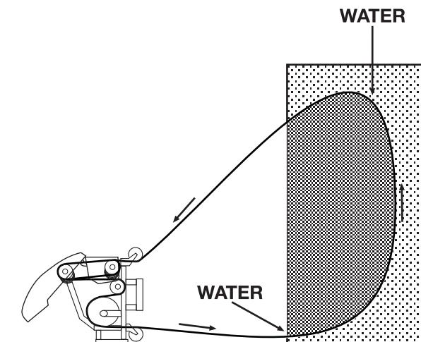
Förutom av kylvattnet från vattenspjuten så spolas wiren vid de två länkhjulenhjulen på maskinen. Detta för att hålla wiren så ren som möjligt vilket medför att sågen kan arbeta med lägre friktionsförluster och högre effektivitet eftersom wiren blir renare.
