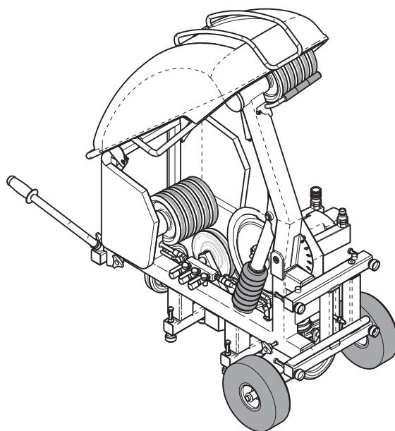
Husqvarna CS 2512 on tarkoitettu käytettäväksi yhdessä hydrauliaggregaatin PP 455 E tai Husqvarna RC 455:n kanssa. Husqvarna CS 2512 on tehokas ja helppokäyttöinen vaijerisaha, jonka suorituskyky riittää todella suuriin tehtäviin, mutta samalla se on riittävän kompakti ja helposti siirrettävä pieni työtehtävä varten. Sitä voidaan käyttää monella tavalla, sekä maasta käsin että seinään kiinnitetynä.
