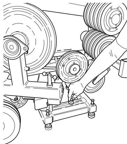
Tänk på att maskinens tyngdpunkt (den grå cirkeln) ligger mellan det första och andra justerfotsparet (justerfotsparen är markerade 1-3) vid liggande snitt (a). Vid snitt under maskinen är det viktigt att förankra sågen väl med ankarbult (b) eftersom justerfotspar 2 och 3 måste användas. (Justerfotspar 1 kommer ev att stödja på den bortsågade delen.) Om inte sågen är väl förankrad kommer den att välna när marerialet som håller upp justerfotspar 1 lossnar.
