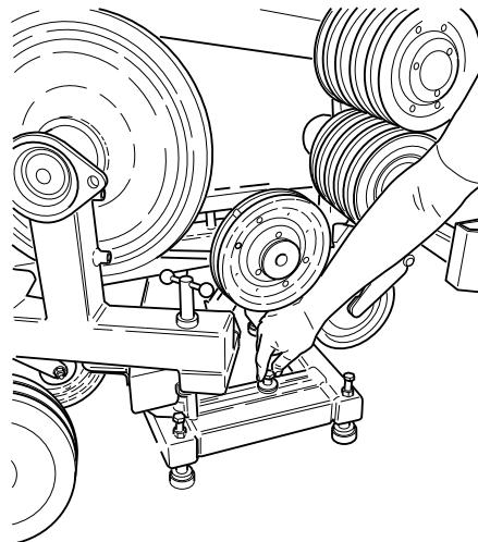
Husk at maskinens tyngdepunkt (den grå sirkelen) ligger mellom det første og andre justeringsfotparet (justeringsfotparene er merket 1-3) ved liggende snitt (a). Ved snitt under maskinen er det viktig å forankre sagen godt med ankerbolt (b) ettersom justeringsfotpar 2 og 3 må brukes. (Justeringsfotpar 1 vil ev. hvile mot den bortsagde delen.) Hvis ikke sagen er ordentlig forankret, vil den velte når materialet som holder justeringspar 1 oppe løsner.
