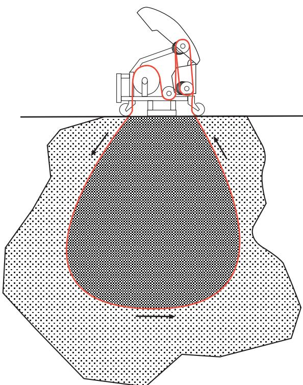
Efter behov kan det være nødvendigt at bore huller for at trække wiren gennem det materiale, der skal saves.
