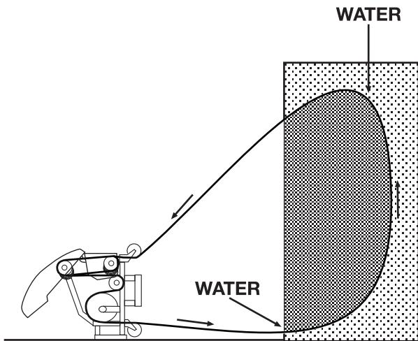
Ud over afkøling via kølevandet fra dysen spules wiren ved de to drejehjul på maskinen. Dette holder wiren så ren som muligt, hvilket betyder, at saven kan arbejde med mindre friktionstab og dermed højere effektivitet.
