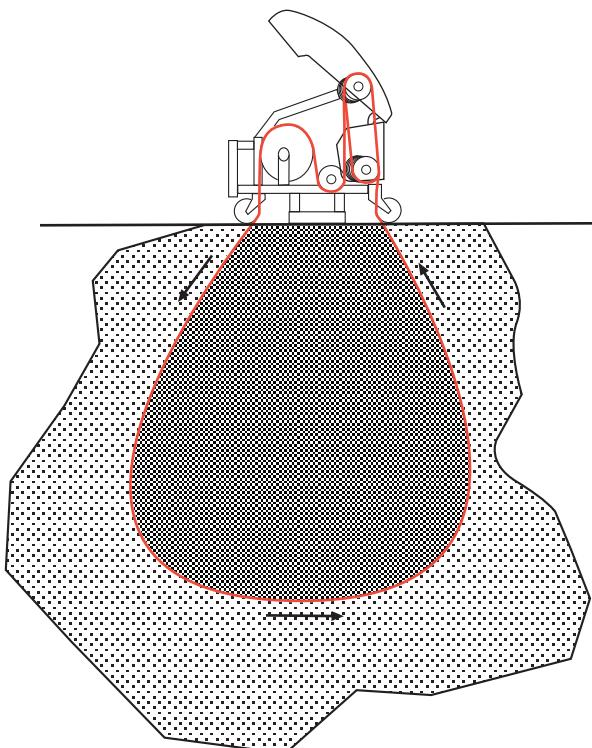
Om det är nödvändigt, borra hål för att trä wiren genom materialet som skall sågas.
