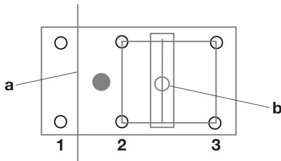
Det kan være nødvendigt at montere ombrydningshjul for at lette savningen. Ved brug af ombrydningshjul kan du reducere antallet af skarpe hjørner, som wiren skal trækkes rundt om, hvilket bevirket, at wiren slides mindre, samtidig med at det bliver lettere at starte saven. Ved brug af ombrydningshjul kan du også styre wiren i forskellige retninger uden at skulle flytte savenheden.
