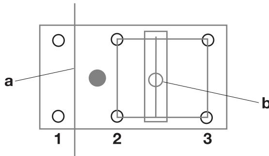
Om nödvändigt, montera brythjul för att underlätta sågningen. Genom att använda brythjul kan antalet skarpa hörn att dra wiren runt minskas, vilket gör att wiren slits mindre samtidigt som det går lättare att starta sågen. Genom att använda brythjul kan man även styra wiren i olika riktningar utan att behöva flytta sågenheten.
