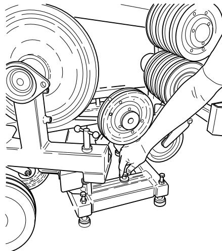
Vær opmærksom på, at maskinens tyngdepunkt (den grå cirkel) ligger mellem det første og andet justeringsfodpar (justeringsfodparrene er markeret 1-3) ved liggende snit (a). Ved snit under maskinen er det vigtigt at forankre saven grundigt med forankringsbolt (b), da justeringsfodpar 2 og 3 skal anvendes. (Justeringsfodpar 1 vil eventuelt komme til at støtte på den afsavede del). Hvis ikke saven er grundigt forankret, vil den vælte, når det materiale, der støtter justeringsfodpar 1, løsnes.
