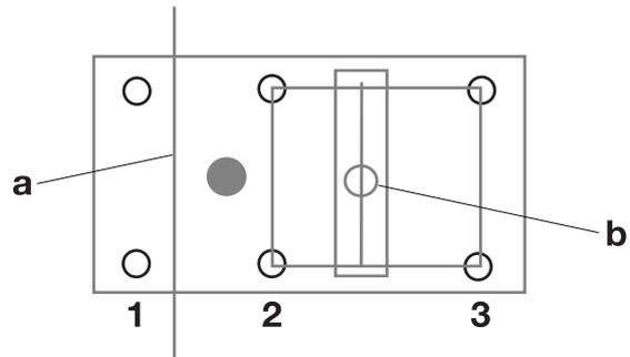
En caso necesario, montar ruedas de retorno para facilitar el corte. Utilizando ruedas de retorno se puede reducir el número de esquinas agudas por las que pasa el cable, con lo que éste se desgasta menos y además es más fácil arrancar la sierra. Utilizando ruedas de retorno también se puede guiar el cable en diferentes direcciones sin necesidad de mover la unidad de sierra.
