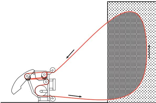
La scie doit être montée en position horizontale pour scier des entailles à hauteur du sol ou dans le sol.
