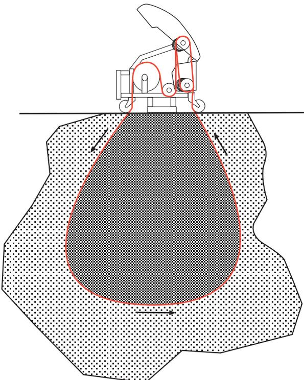
Falls erforderlich, bohren Sie Löcher, um das Seil durch das zu schneidende Material zu verlegen.
