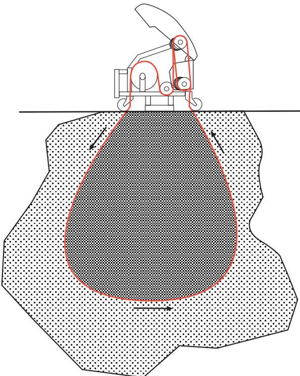
En caso necesario, taladre agujeros para insertar el cable a través del material que se va a cortar.
