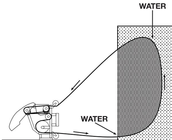
Le câble est aspergé par l'eau de refroidissement de la lance à eau, ainsi qu'au niveau des deux roues d'articulation de la machine. Ceci permet de maintenir le câble aussi propre que possible et donc d'utiliser la scie avec un minimum de pertes dues au frottement et une meilleure efficacité.
