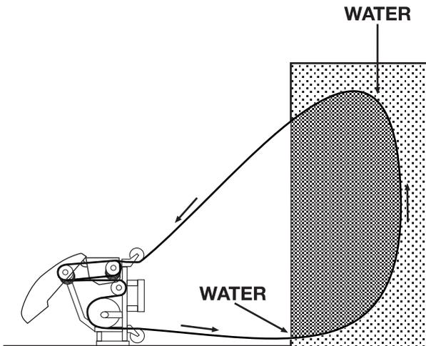
Neben dem Kühlwasser von den Wasserlanzen wird das Seil an den beiden Lenkrollen in der Maschine gespült. So bleibt das Seil möglichst sauber und die Säge kann mit geringeren Reibungsverlusten sowie höherer Effektivität arbeiten.
