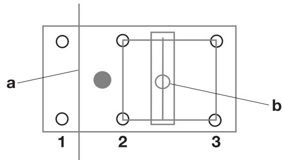
Si nécessaire, montez des roues de cisaillement pour faciliter le sciage. L'utilisation de roues de cisaillement permet de minimiser le nombre d'angles tranchants autour desquels le câble doit passer, ce qui permet de réduire l'usure du câble tout en facilitant le démarrage de la scie. L'utilisation de roues de cisaillement permet également de déplacer le câble dans différentes directions sans avoir besoin de déplacer l'unité de sciage.
