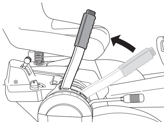
Premendo il pulsante di bloccaggio e portando la leva in avanti, il gruppo si abbassa e le lame iniziano automaticamente a ruotare (posizione di taglio).
