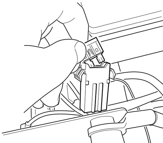
Non usare altri tipi di fusibile in caso di sostituzione.
