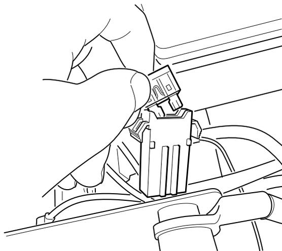
Eviter d'utiliser un autre type de fusible lors du remplacement.
