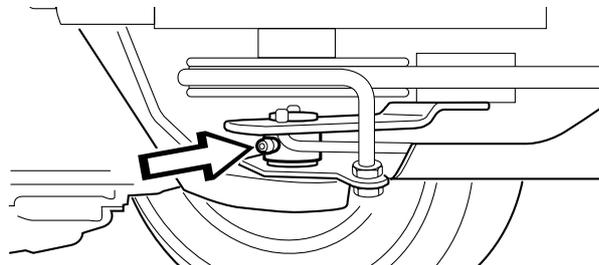
Si la machine est utilisée tous les jours, le graissage doit être effectué deux fois par semaine.
