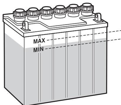
Lors du remplissage, il convient de n'utiliser que de l'eau distillée pour remplir les cellules.
