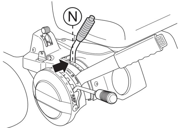
Pour que la vitesse arrière puisse être passée, le bouton de verrouillage du levier des vitesses doit être enfoncé.
