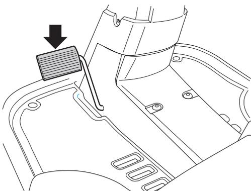
L'entraînement des couteaux n'est pas modifié par la pédale de débrayage.
