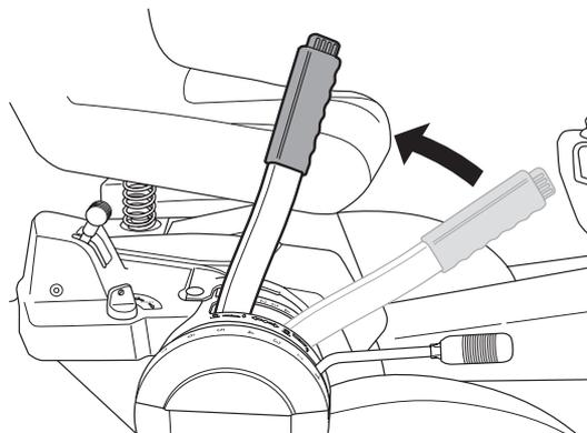
Si le bouton de verrouillage est enfoncé et si le levier est poussé vers l'avant, l'unité est abaissée et les couteaux commencent automatiquement à tourner (position de coupe).
