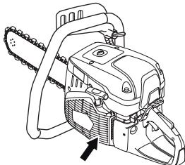
**ИЗВЕСТИЕ!** Замърсен или блокиран смукателен въздухопровод предизвиква прегряване на машината, което води до повреждане на буталото и цилиндъра.
