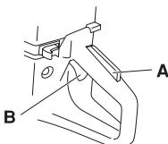
Фиксаторът на дроселната клапа остава в натиснато положение, докато се подава газ. При пускане на ръкохватката, регулаторът за газта и фиксаторът на регулаторът за газта се връщат в съответните си изходни положения. Това се постига чрез две независими една от друга възвратни пружинни системи. При това положение регулаторът за газта автоматично се застопорява на празен ход.
