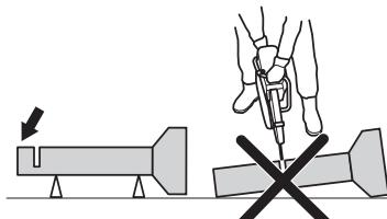
Ако тръбата провисне и затвори прореза, режещият диск ще бъде зашипван в зоната на откат и е възможно да възникне силен откат. Ако тръбата е добре застопорена, краят на тръбата ще се двини надолу, прорезът ще се разтваря и няма да се получи зашипване.
