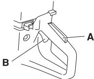
Фиксаторът на дроселната клапа остава в натиснато положение, докато се подава газ. При пускане на ръкохватката, регулаторът за газта и фиксаторът на регулаторът за газта се връщат в съответните си изходни положения. Това се постига чрез две независими една от друга възвратни пружини системи. При това положение регулаторът за газта автоматично се застопорява на празен ход.
