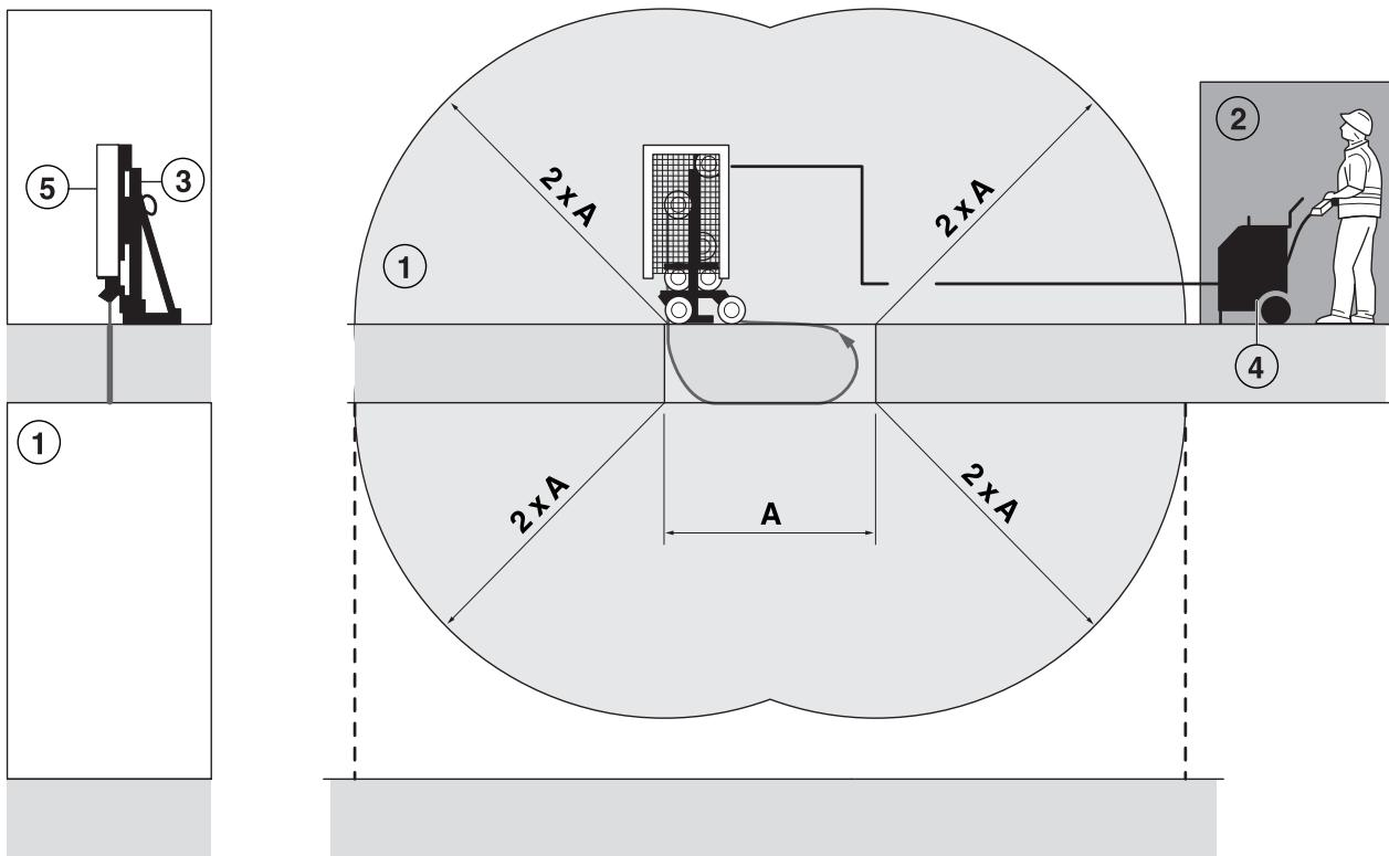
(A) Μεγαλύτερο τμήμα σύρματος ελεύθερης λειτουργίας
