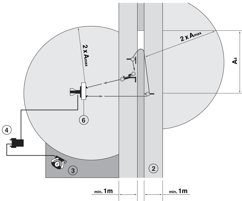
(A<sub>max</sub>) Maior secção de fio livre (A<sub>1</sub>-A<sub>4</sub>)
