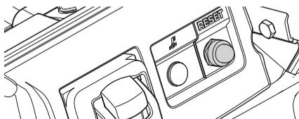
Si le témoin s'allume et que la protection contre les surcharges se déclenche, le témoin doit d'abord s'éteindre avant qu'on puisse le réinitialiser.
