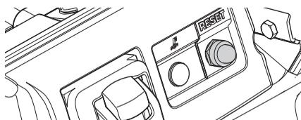
Si la luz está encendida y se desencadena la protección contra sobrecarga, la luz debe apagarse antes de que se pueda restablecer.
