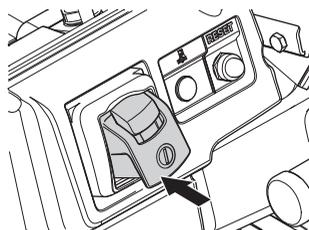
Un interrupteur défectueux doit être remplacé par un atelier d'entretien agréé.
